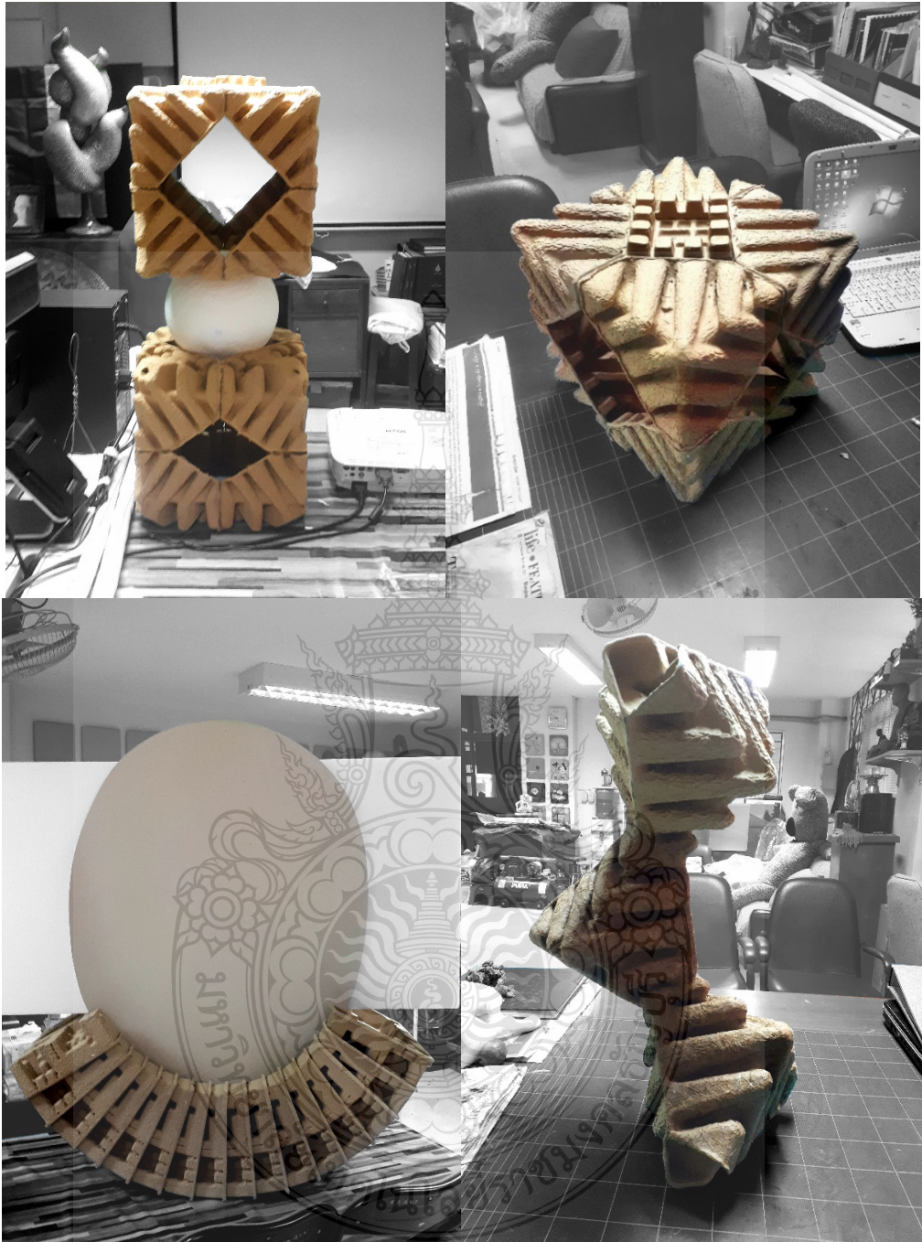
ภาพที่ 3.13 การนำชิ้นส่วนเศษวัสดุมาทดลองประกอบเพื่อหาความเป็นไปได้ของ รูปทรงให้ตรงกับแนวคิด ชุดที่ 2
