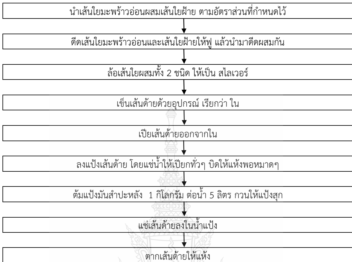
รูปที่ 3.2 กระบวนการผลิตเส้นด้ายผสมระหว่างเส้นใยมะพร้าวและเส้นใยฝ้าย ที่มา : [30]
