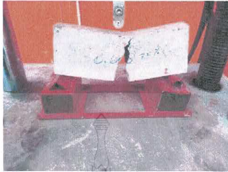
รูปที่ 9 คานตัวอย่างขนาดกลางหลังการวิบัติ
