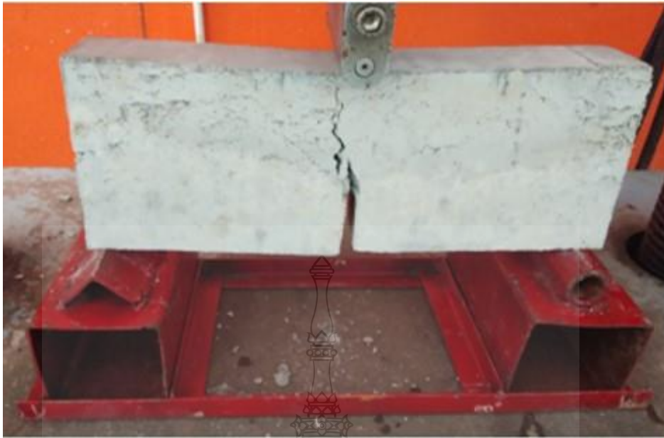
รูปที่ 4.7 คานตัวอย่างภายหลังจากการวิบัติ
