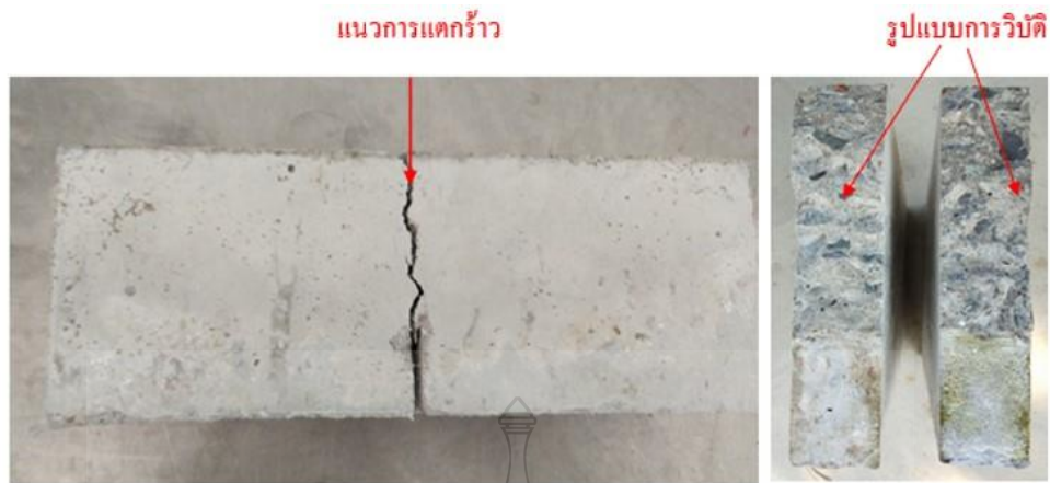
รูปที่ 4.10 รูปแบบการวิบัติตัวอย่างคานคอนกรีตขนาดใหญ่
