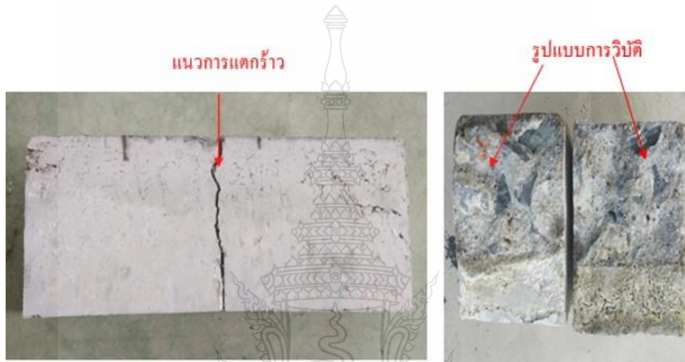
รูปที่ 4.8 รูปแบบการวิบัติของตัวอย่างคานคอนกรีตรีไซเคิลขนาดเล็ก
