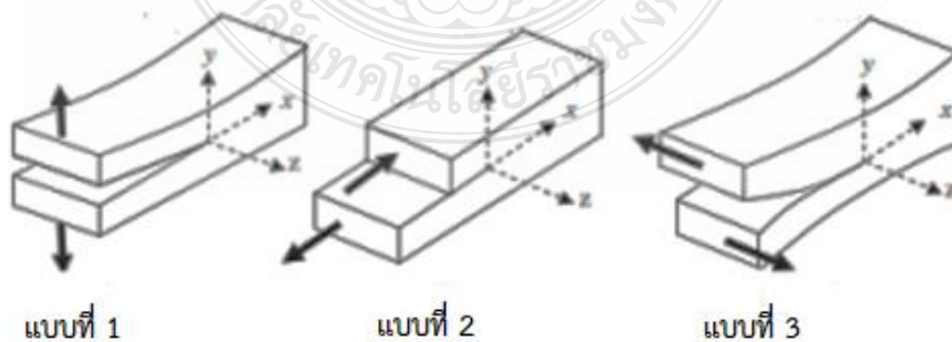
รูปที่ 2.14 ลักษณะของรูปแบบของการเสียรูปทรง [33]
