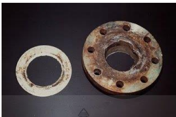
รูปที่ 2.5 การกัดกร่อนในที่อับ [13]
