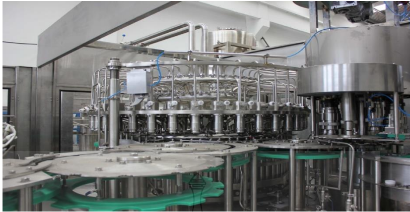
รูปที่ 1.2 ส่วนของท่อส่งน้ำผลไม้เข้าสู่กระบวนการผลิต
