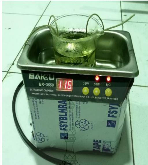
รูปที่ 3.12 การกำจัดออกไซด์ด้วยเครื่องอัลตราโซนิก
