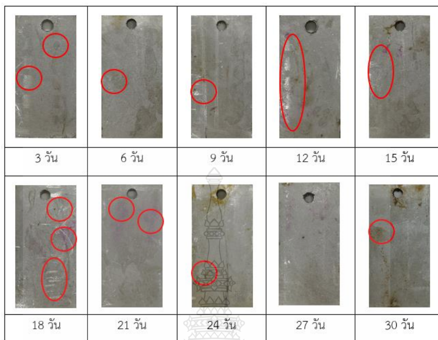
รูปที่ 4.21 ชิ้นทดสอบเหล็กกล้าไร้สนิม AISI316L ที่ได้จากการทดลองในสารละลายน้ำส้ปะรด
