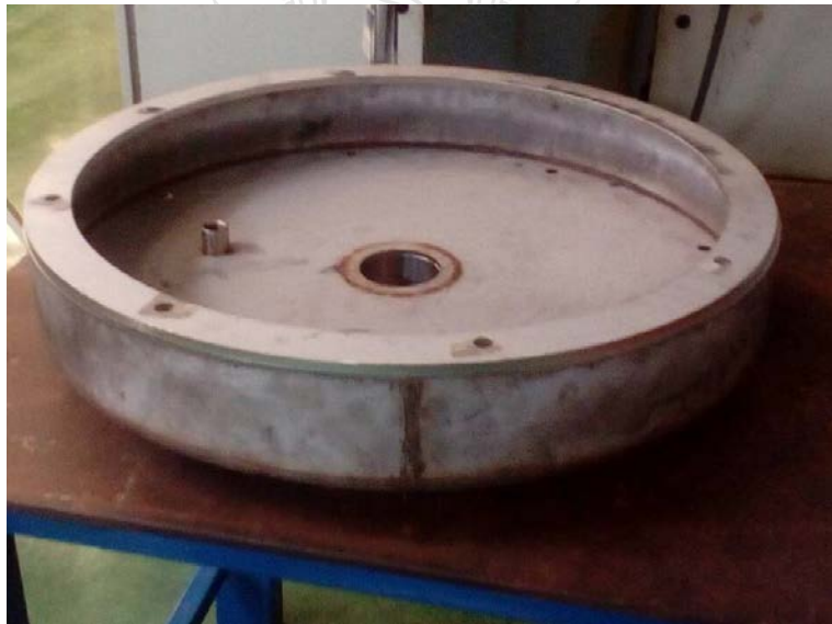
รูปที่ ค.2 ชั้นส่วนโครงสร้างห้องเผาไหม้ส่วนฝา
