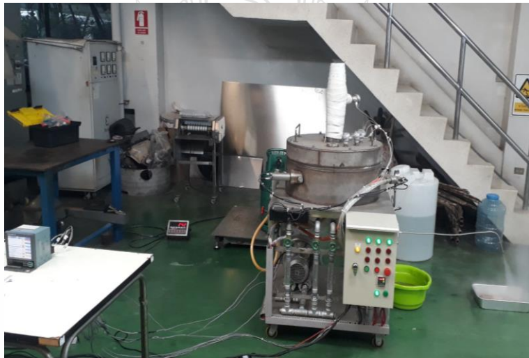
รูปที่ ค.22 การทดลองที่ 2 เตินระบบเครื่องกำเนิดไอน้ำแบบท่อขด และเก็บข้อมูลการทดลอง
