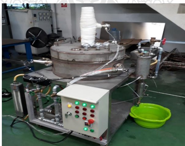
รูปที่ 3.2 การทดสอบสมรรถนะของเครื่องกำเนิดไอน้ำแบบท่อขด (STSG) โดยการปรับค่าอากาศส่วนเกิน (Excess Air) ที่ 0, 5, 10, 15, 20 %
