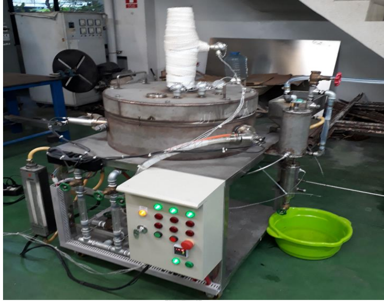
รูปที่ ค.21 การทดลองที่ 1 เตินระบบเครื่องกำเนิดไอน้ำแบบท่อขด และเก็บข้อมูลการทดลอง
