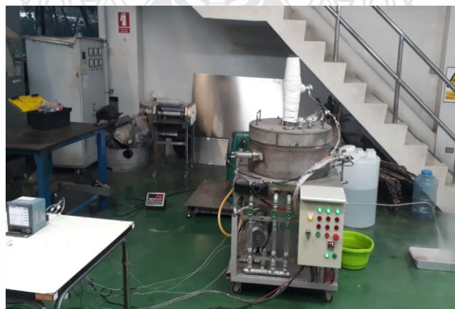
รูปที่ 3.4 การทดสอบสมรรถนะของเครื่องกำเนิดไอน้ำแบบท่อขด (STSG) โดยการปรับอัตราน้ำป้อนที่ 16, 19, 22, 25, 28 kg/h
