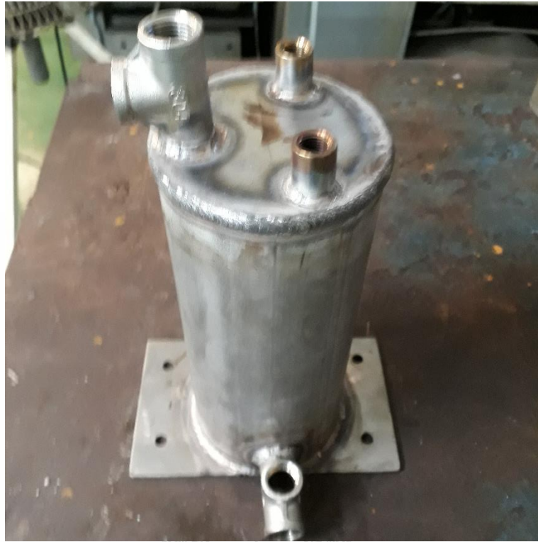
รูปที่ ค.19 ถังป้อนน้ำเข้าระบบ
