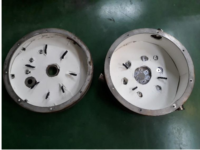
รูปที่ ค.3 การวางเซรามิกซ์เปเปอร์เพื่อเป็นฉนวนภายในห้องเผาไหม้
