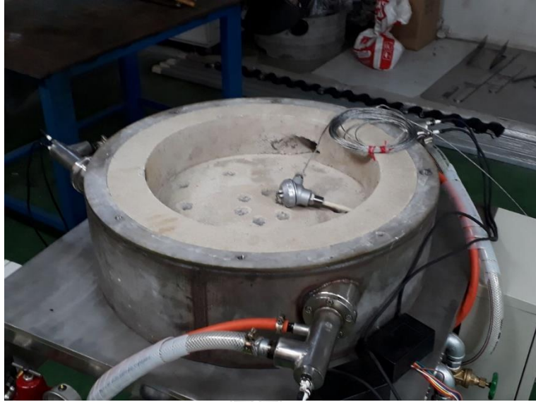
รูปที่ ค.9 การประกอบชุดหัวเผาไหม้ของเครื่องกำเนิดไอน้ำแบบท่อซด
