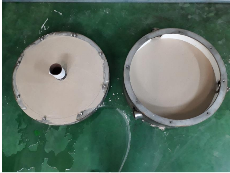
รูปที่ ค.5 การเทคอนกรีตทนไฟในส่วนฝาของห้องเผาไหม้
