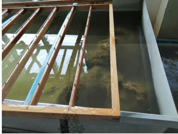
รูปที่ 3.4 การล้างเยื่อฟางข้าวและเยื่อปอสา ให้สะอาดแล้วกรองน้ำออกจากเครื่องกระจายเยื่อ
