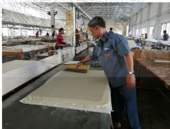
รูปที่ 3.9 การทำแห้งแผ่นกระดาษจากฟางข้าว
