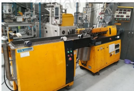
ภาพที่ 3.5 เครื่องอัดรีดแบบสกรูคู่ (LAB TECH LTE-20-32)
