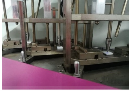
ภาพที่ 3.16 ลักษณะห้วกดและการวางชิ้นงานในการทดสอบอุณหภูมิอ่อนตัวไวแคต
