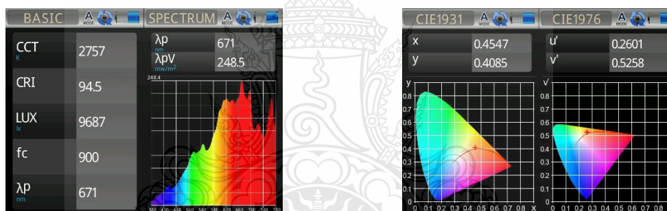
ภาพที่ 4.7 คุณสมบัติทางแสง การจัดแสงโคร มาคีย์ ฉากสีเขียว อุณหภูมิสีของแสงเทียบเคียง 2757K
