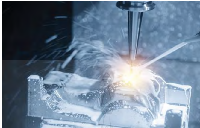
ภาพที่ 2.1 การใช้น้ำมันหล่อเย็นขณะตัดชิ้นงานโลหะ [26]
