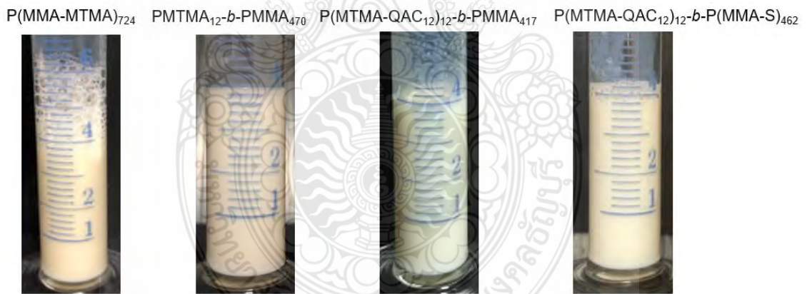
ภาพที่ ค.21 ปริมาตรฟองของ น้ำมันแร่ : อนุภาคพอลิเมอร์ที่อัตราส่วน 1:10
