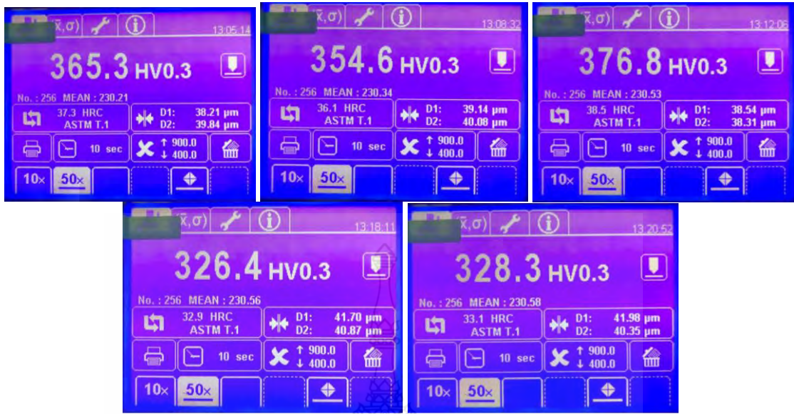
รูปที่ ก.48 ผลการวัดค่าความแข็งชิ้นงานที่ตัดเจาะด้วยกระแสไฟฟ้า เวลาเปิด 25 \mu s กระแสไฟฟ้า 10 A ช่องว่างระหว่างชิ้นงานกับอิเล็กโทรด 15 \mu m
