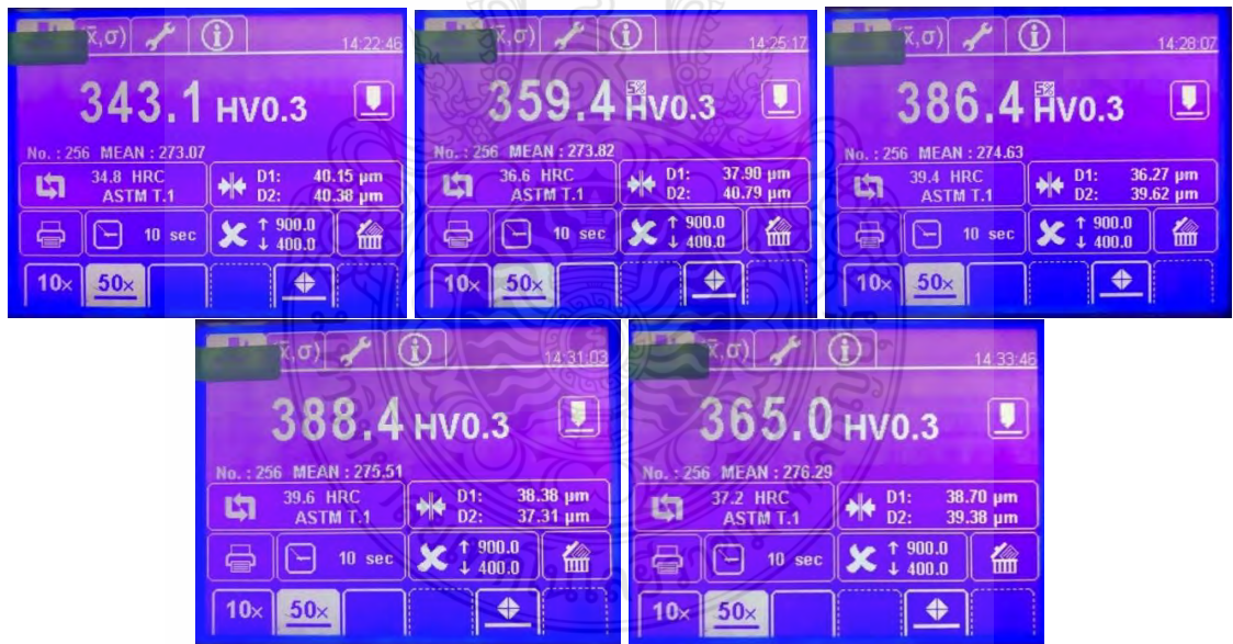
รูปที่ ก.35 ผลการวัดค่าความแข็งชิ้นงานที่ตัดเจาะด้วยกระแสไฟฟ้า เวลาเปิด 12 μs กระแสไฟฟ้า 22 A ช่องว่างระหว่างชิ้นงานกับอิเล็กโทรด 10 μm
