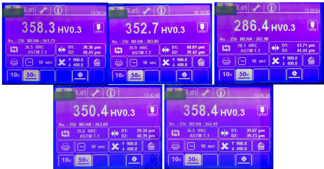
รูปที่ ก.30 ผลการวัดค่าความแข็งชิ้นงานที่ตัดเจาะด้วยกระแสไฟฟ้า เวลาเปิด 12 μs กระแสไฟฟ้า 10 A ช่องว่างระหว่างชิ้นงานกับอิเล็กโทรด 15 μm
