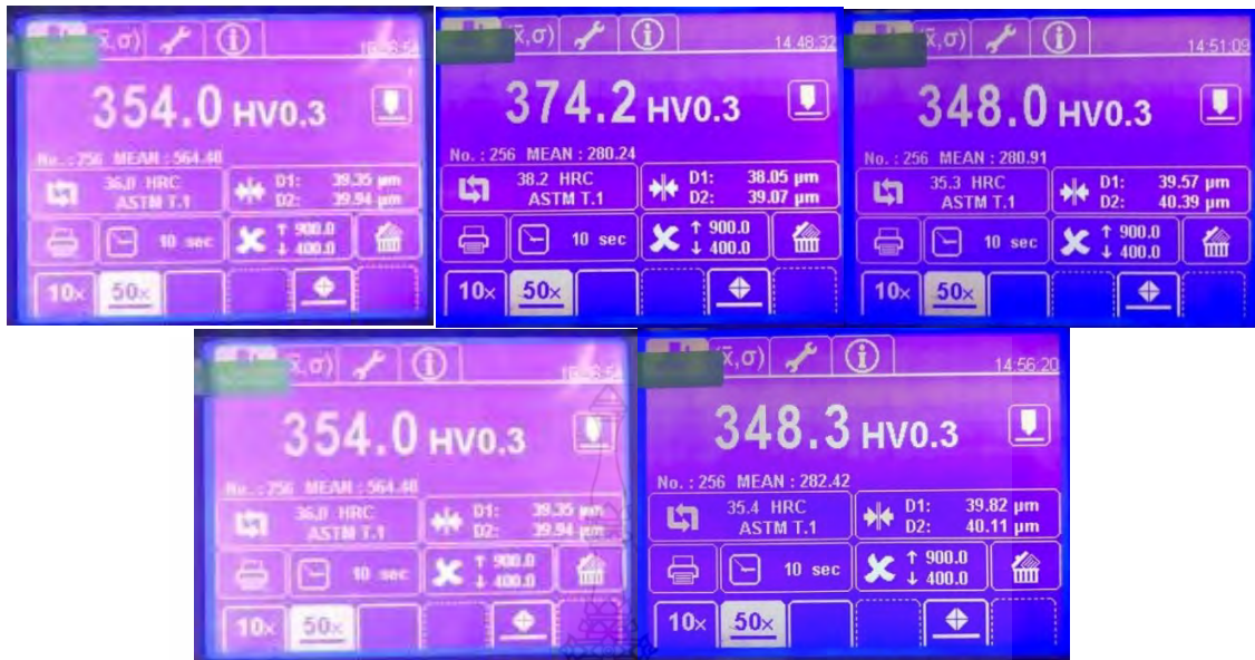
รูปที่ ก.36 ผลการวัดค่าความแข็งชิ้นงานที่ตัดเจาะด้วยกระแสไฟฟ้า เวลาเปิด 12 \mu\text{s} กระแสไฟฟ้า 22 A ช่องว่างระหว่างชิ้นงานกับอิเล็กโทรด 15 \mu\text{m}
