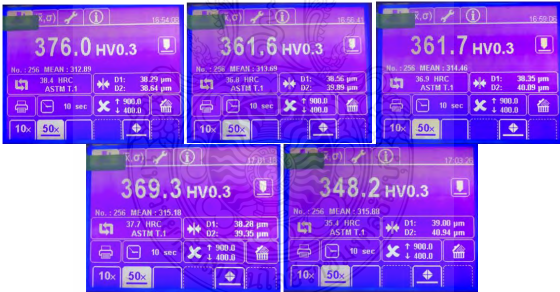
รูปที่ ก.43 ผลการวัดค่าความแข็งชิ้นงานที่ตัดเจาะด้วยกระแสไฟฟ้า เวลาเปิด 18 µs กระแสไฟฟ้า 22 A ช่องว่างระหว่างชิ้นงานกับอิเล็กโทรด 5 µm
