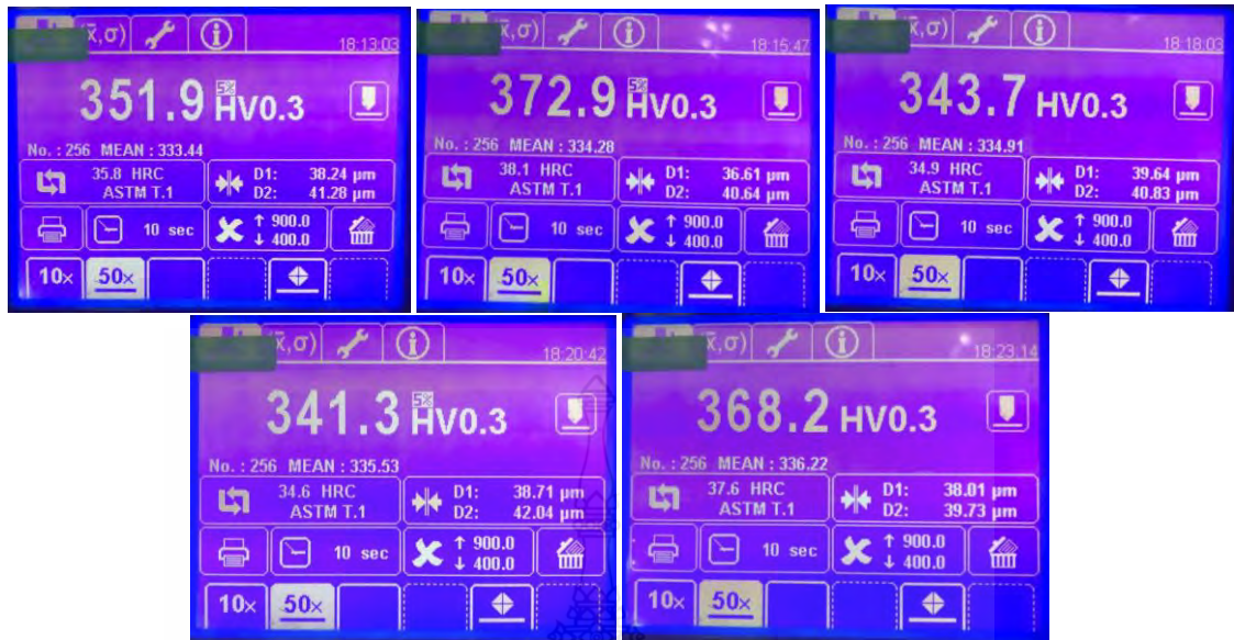
รูปที่ ก.50 ผลการวัดค่าความแข็งชิ้นงานที่ตัดเจาะด้วยกระแสไฟฟ้า เวลาเปิด 25 \mu s กระแสไฟฟ้า 16 A ช่องว่างระหว่างชิ้นงานกับอิเล็กโทรด 10 \mu m
