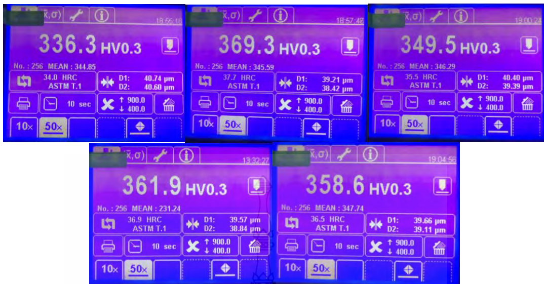
รูปที่ ก.40 ผลการวัดค่าความแข็งชิ้นงานที่ตัดเจาะด้วยกระแสไฟฟ้า เวลาเปิด 18 µs กระแสไฟฟ้า 16 A ช่องว่างระหว่างชิ้นงานกับอิเล็กโทรด 5 µm
