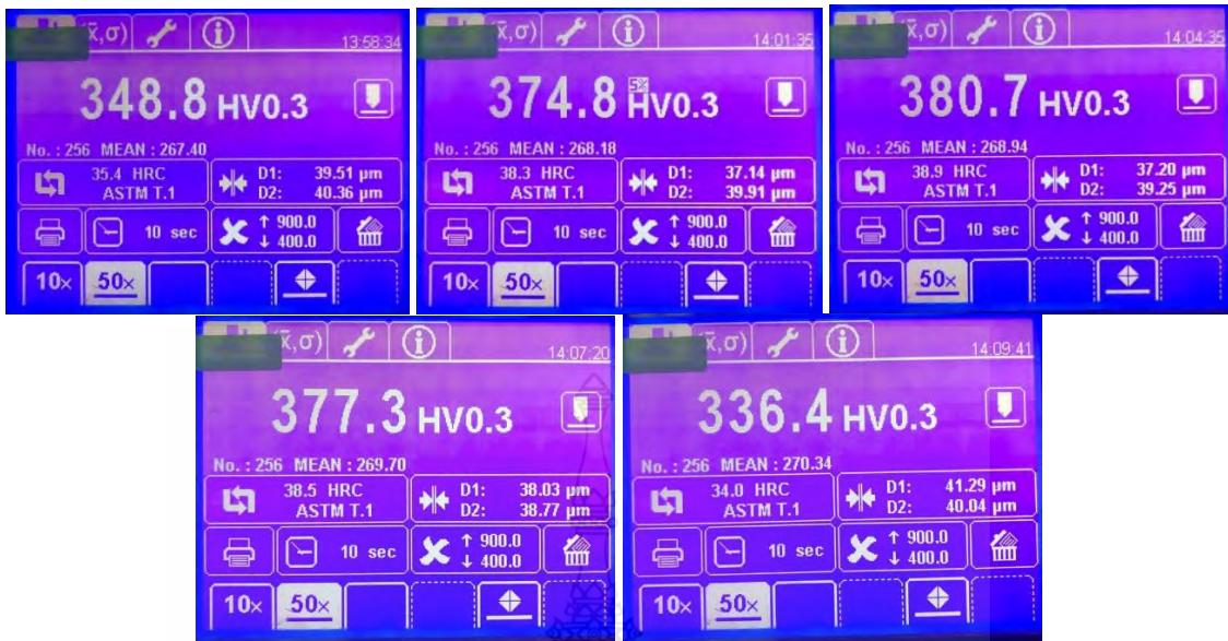
รูปที่ ก.34 ผลการวัดค่าความแข็งชิ้นงานที่ตัดเจาะด้วยกระแสไฟฟ้า เวลาเปิด 12 μs กระแสไฟฟ้า 22 A ช่องว่างระหว่างชิ้นงานกับอิเล็กโทรด 5 μm
