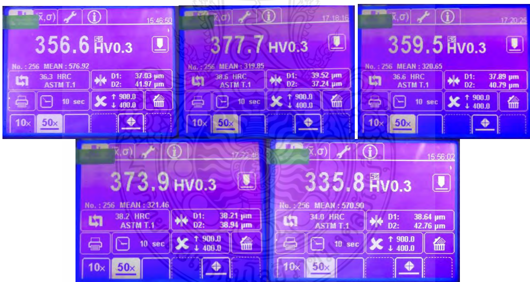
รูปที่ ก.41 ผลการวัดค่าความแข็งชิ้นงานที่ตัดเจาะด้วยกระแสไฟฟ้า เวลาเปิด 18 µs กระแสไฟฟ้า 16 A ช่องว่างระหว่างชิ้นงานกับอิเล็กโทรด 10 µm
