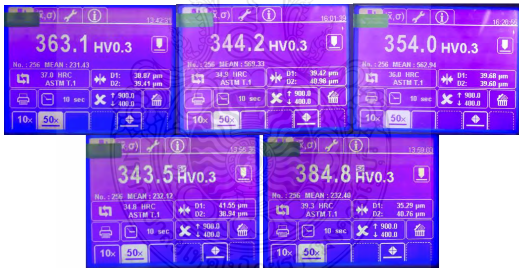
รูปที่ ก.53 ผลการวัดค่าความแข็งชิ้นงานที่ตัดเจาะด้วยกระแสไฟฟ้า เวลาเปิด 25 µs กระแสไฟฟ้า 22 A ช่องว่างระหว่างชิ้นงานกับอิเล็กโทรด 10 µm
