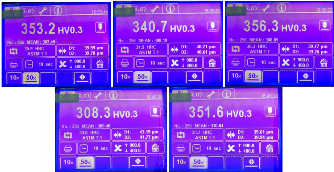
รูปที่ ก.42 ผลการวัดค่าความแข็งชิ้นงานที่ตัดเจาะด้วยกระแสไฟฟ้า เวลาเปิด 18 µs กระแสไฟฟ้า 16 A ช่องว่างระหว่างชิ้นงานกับอิเล็กโทรด 15 µm
