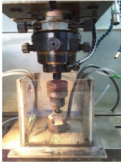
รูปที่ 3.8 การจับยึดชิ้นงานกับแท่งอิเล็กโทรดในถังน้ำมันไดอิเล็กตริก
