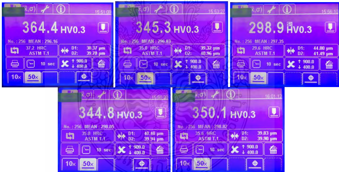
รูปที่ ก.39 ผลการวัดค่าความแข็งชิ้นงานที่ตัดเจาะด้วยกระแสไฟฟ้า เวลาเปิด 18 µs กระแสไฟฟ้า 10 A ช่องว่างระหว่างชิ้นงานกับอิเล็กโทรด 15 µm
