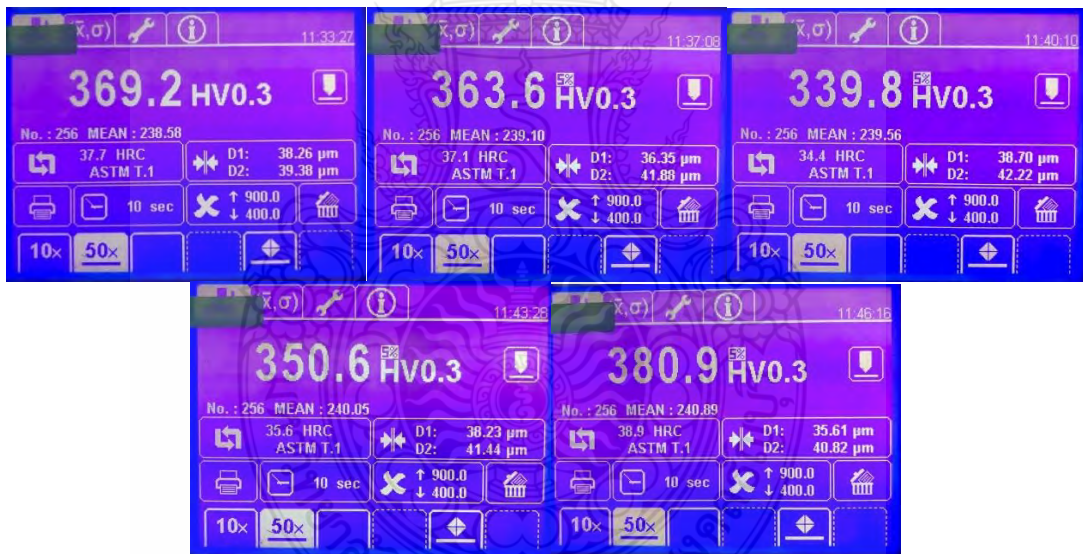
รูปที่ ก.29 ผลการวัดค่าความแข็งชิ้นงานที่ตัดเจาะด้วยกระแสไฟฟ้า เวลาเปิด 12 μs กระแสไฟฟ้า 10 A ช่องว่างระหว่างชิ้นงานกับอิเล็กโทรด 10 μm
