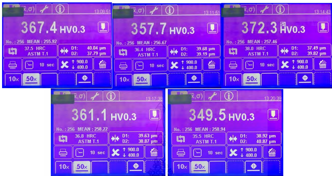
รูปที่ ก.32 ผลการวัดค่าความแข็งชิ้นงานที่ตัดเจาะด้วยกระแสไฟฟ้า เวลาเปิด 12 µs กระแสไฟฟ้า 16 A ช่องว่างระหว่างชิ้นงานกับอิเล็กโทรด 10 µm
