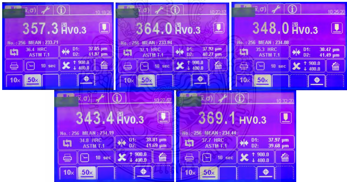
รูปที่ ก.49 ผลการวัดค่าความแข็งชิ้นงานที่ตัดเจาะด้วยกระแสไฟฟ้า เวลาเปิด 25 \mu s กระแสไฟฟ้า 16 A ช่องว่างระหว่างชิ้นงานกับอิเล็กโทรด 5 \mu m
