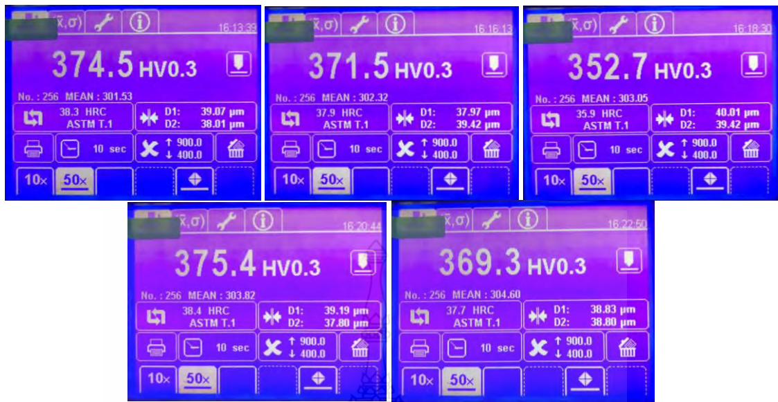
รูปที่ ก.44 ผลการวัดค่าความแข็งชิ้นงานที่ตัดเจาะด้วยกระแสไฟฟ้า เวลาเปิด 18 µs กระแสไฟฟ้า 22 A ช่องว่างระหว่างชิ้นงานกับอิเล็กโทรด 10 µm
