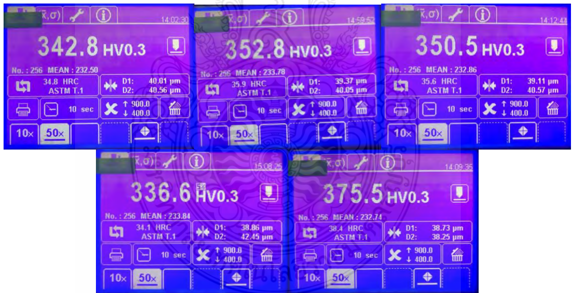
รูปที่ ก.51 ผลการวัดค่าความแข็งชิ้นงานที่ตัดเจาะด้วยกระแสไฟฟ้า เวลาเปิด 25 \mu s กระแสไฟฟ้า 16 A ช่องว่างระหว่างชิ้นงานกับอิเล็กโทรด 15 \mu m
