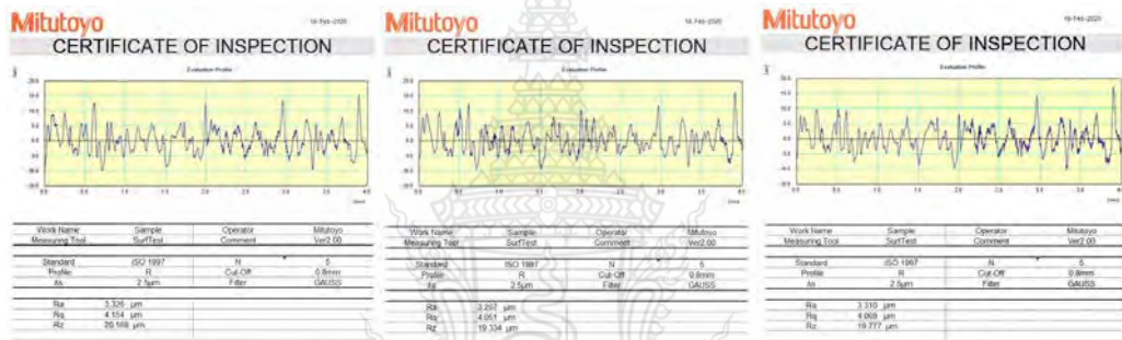
รูปที่ ก.5 ผลการวัดความหยาบผิวชิ้นงานที่ เวลาเปิด 12 ไมโครวินาที กระแสไฟฟ้า 16 แอมป์ และ ช่องว่างระหว่างชิ้นงานกับอิเล็กโทรด 10 ไมโครเมตร
