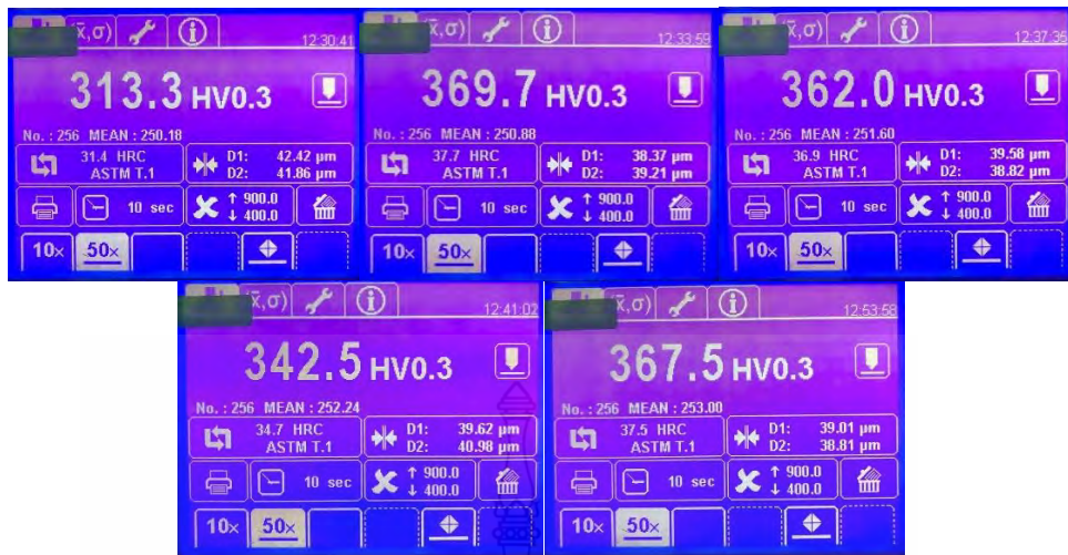
รูปที่ ก.28 ผลการวัดค่าความแข็งชิ้นงานที่ตัดเจาะด้วยกระแสไฟฟ้า เวลาเปิด 12 μs กระแสไฟฟ้า 10 A ช่องว่างระหว่างชิ้นงานกับอิเล็กโทรด 5 μm
