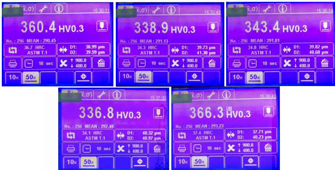
รูปที่ ก.38 ผลการวัดค่าความแข็งชิ้นงานที่ตัดเจาะด้วยกระแสไฟฟ้า เวลาเปิด 18 µs กระแสไฟฟ้า 10 A ช่องว่างระหว่างชิ้นงานกับอิเล็กโทรด 10 µm
