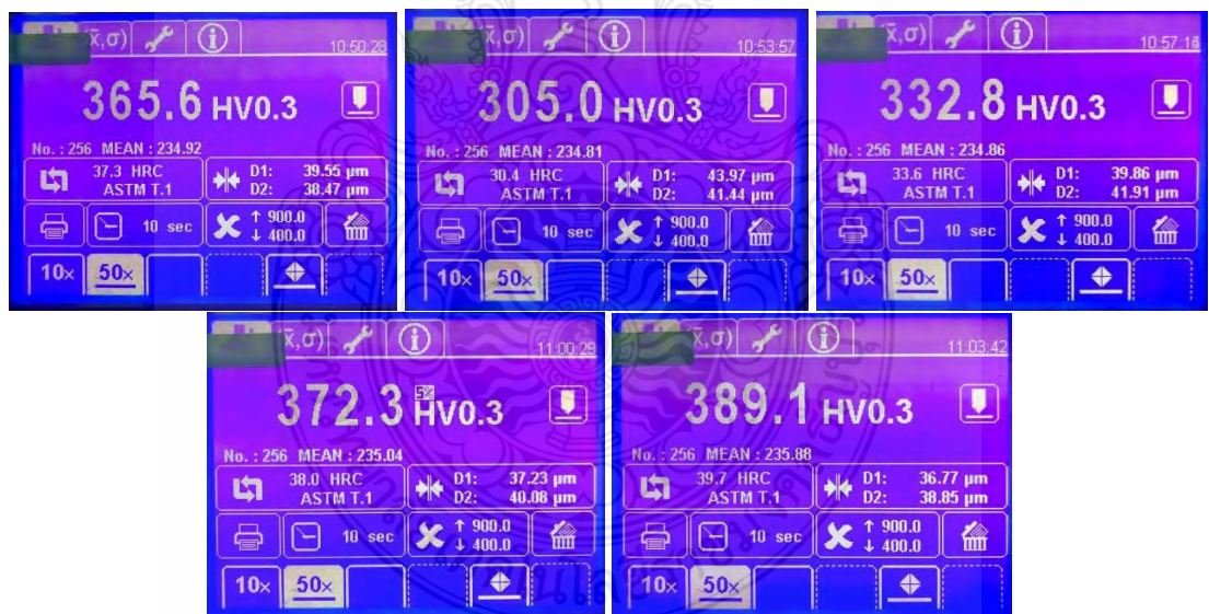
รูปที่ ก.31 ผลการวัดค่าความแข็งชิ้นงานที่ตัดเจาะด้วยกระแสไฟฟ้า เวลาเปิด 12 μs กระแสไฟฟ้า 16 A ช่องว่างระหว่างชิ้นงานกับอิเล็กโทรด 5 μm
