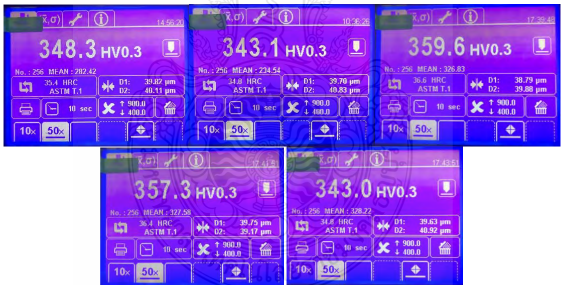
รูปที่ ก.45 ผลการวัดค่าความแข็งชิ้นงานที่ตัดเจาะด้วยกระแสไฟฟ้า เวลาเปิด 18 µs กระแสไฟฟ้า 22 A ช่องว่างระหว่างชิ้นงานกับอิเล็กโทรด 15 µm
