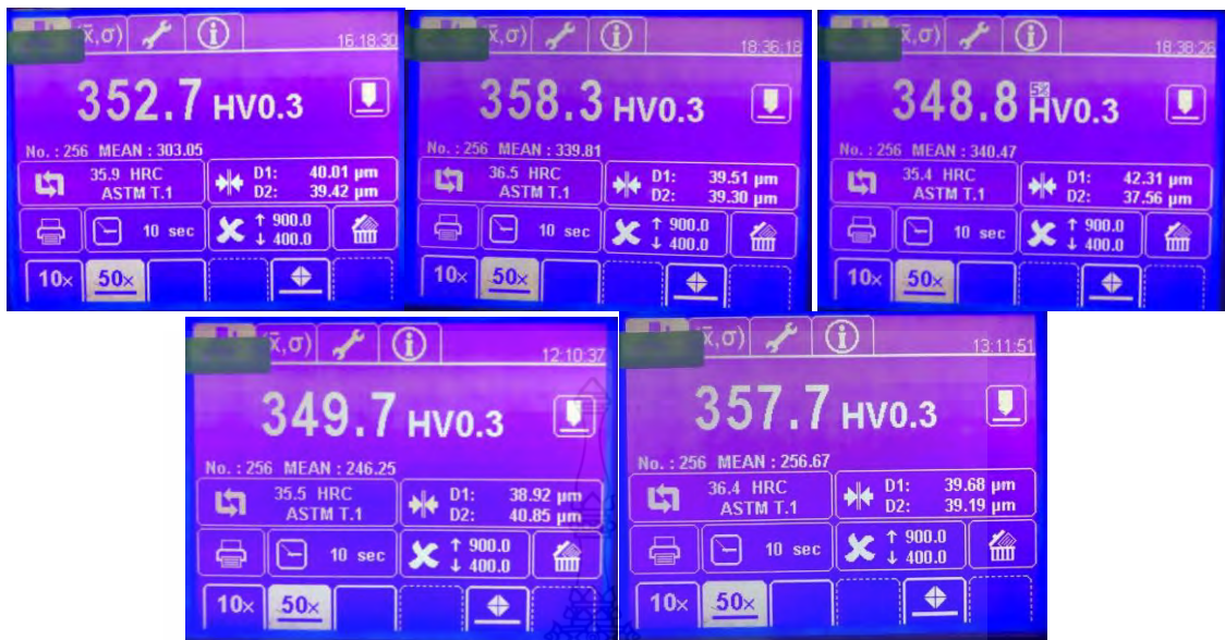
รูปที่ ก.54 ผลการวัดค่าความแข็งชิ้นงานที่ตัดเจาะด้วยกระแสไฟฟ้า เวลาเปิด 25 µs กระแสไฟฟ้า 22 A ช่องว่างระหว่างชิ้นงานกับอิเล็กโทรด 15 µm
