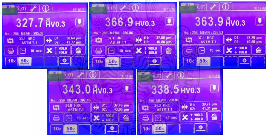
รูปที่ ก.37 ผลการวัดค่าความแข็งชิ้นงานที่ตัดเจาะด้วยกระแสไฟฟ้า เวลาเปิด 18 \mu\text{s} กระแสไฟฟ้า 10 A ช่องว่างระหว่างชิ้นงานกับอิเล็กโทรด 5 \mu\text{m}
