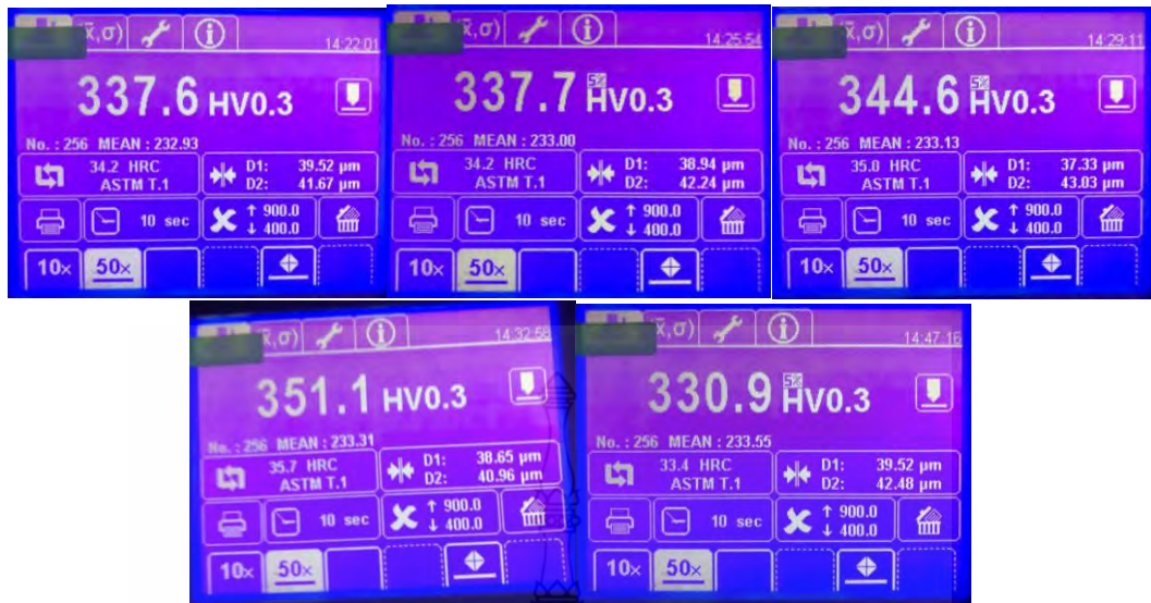
รูปที่ ก.46 ผลการวัดค่าความแข็งชิ้นงานที่ตัดเจาะด้วยกระแสไฟฟ้า เวลาเปิด 25 µs กระแสไฟฟ้า 10 A ช่องว่างระหว่างชิ้นงานกับอิเล็กโทรด 5 µm
