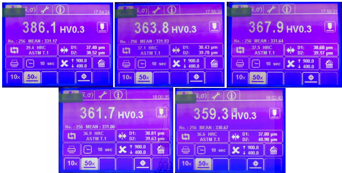
รูปที่ ก.52 ผลการวัดค่าความแข็งชิ้นงานที่ตัดเจาะด้วยกระแสไฟฟ้า เวลาเปิด 25 µs กระแสไฟฟ้า 22 A ช่องว่างระหว่างชิ้นงานกับอิเล็กโทรด 5 µm
