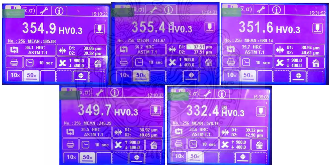
รูปที่ ก.33 ผลการวัดค่าความแข็งชิ้นงานที่ตัดเจาะด้วยกระแสไฟฟ้า เวลาเปิด 12 µs กระแสไฟฟ้า 16 A ช่องว่างระหว่างชิ้นงานกับอิเล็กโทรด 15 µm
