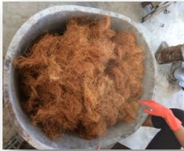
รูปที่ 3.9 การผสมวัสดุประสานกับเส้นใยมะพร้าว
