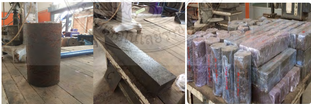
รูปที่ 3.12 ถอดแบบหล่อพร้อมหุ้มแผ่นพลาสติกใสบ่มแท่งตัวอย่าง
