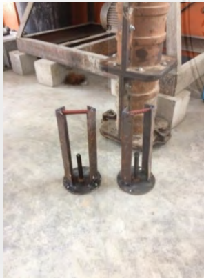
รูปที่ 3.10 การอัดขึ้นรูปแท่งทรงกระบอก \varnothing 15X30 ซม.
