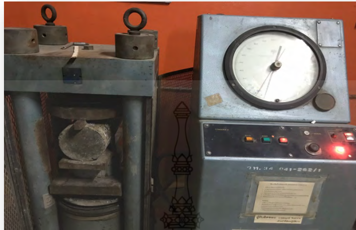
รูปที่ 3.19 การทดสอบกำลังรับแรงดึงแบบผ่าซีก
