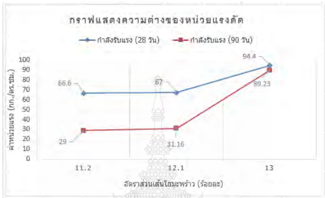
รูปที่ 4.6 ความสัมพันธ์ระหว่างหน่วยแรงดัดและอัตราส่วนเส้นใยมะพร้าว
