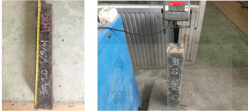
รูปที่ 3.16 วัดขนาด และชั่งน้ำหนักตัวอย่างแท่งคานสี่เหลี่ยม
