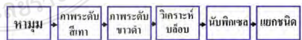
รูปที่ 2 ขั้นตอนวิธีการแยกชนิดกระดาษลูกฟูกด้านมูม
