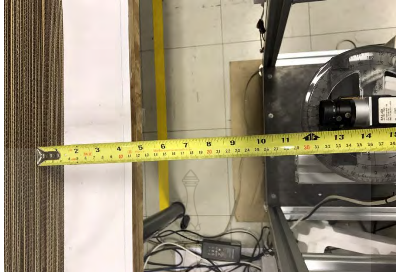
ภาพที่ 4.4 ระยะการรับภาพที่ 330 มิลลิเมตรจากขอบกระดาษลูกฟูกถึงหน้าเลนส์กล้อง
