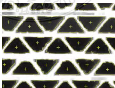
ภาพที่ 2.14 การวิเคราะห์กลุ่มภาพที่เป็นแบบไบนารีเพื่อหาเส้นรอบวัตถุ
