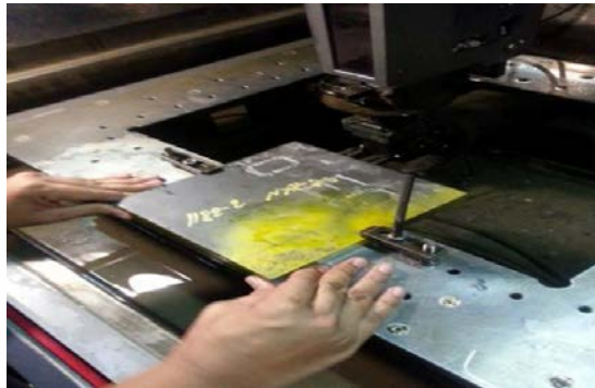
รูปที่ 3.5 แสดงการจับยึดเหล็กกล้าแม่พิมพ์บน โต๊ะของเครื่องตัดโลหะด้วยไฟฟ้า
