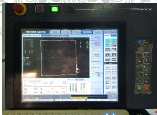
รูปที่ 3.6 การเคลื่อนตัดชิ้นงานตาม โปรแกรมที่ได้เขียนไว้
