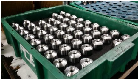
รูปที่ 12 การนำเอาแผ่นโฟมมาช่วยในการวางชิ้นงาน
