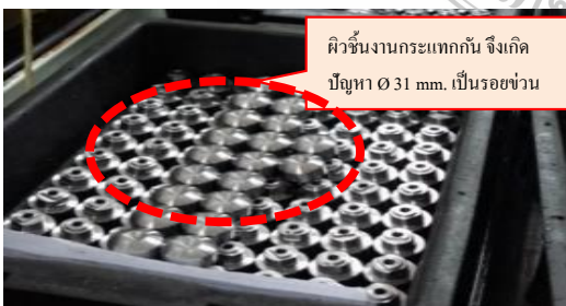
รูปที่ 9 ปัญหาการวางชิ้นงานซ้อนกันลงภาชนะ
