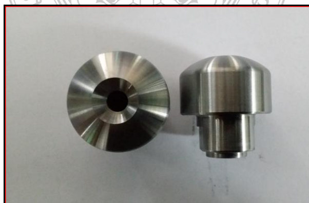
รูปที่ 3.23 ชิ้นงานจากกระบวนการการกลึงละเอียด
