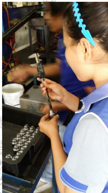
รูปที่ 3.24 การใช้เวอร์เนียคาลิปเปอร์ตรวจสอบขนาดชิ้นงาน
