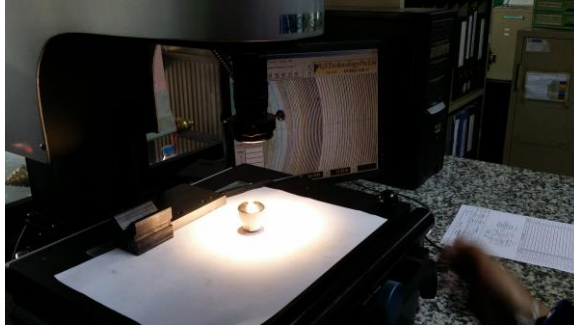
รูปที่ 3.27 เครื่องมือวัดชิ้นงานแบบ 3 มิติ
