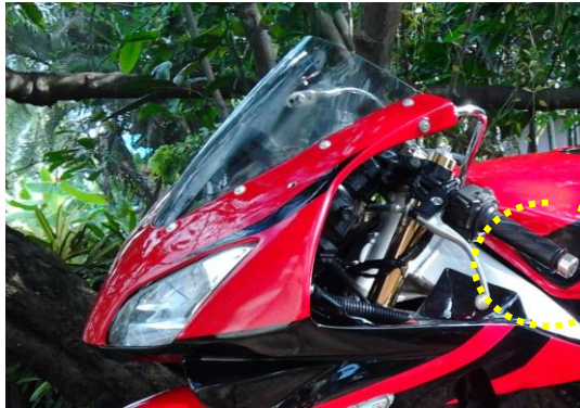
รูปที่ 2.3 ตำแหน่งติดตั้งค้ำน้ำหนักปลายแฮนด์ (WEIGHT HAND)
