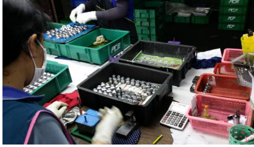
รูปที่ 3.25 การใช้ปลั๊กเกจตรวจสอบขนาดชิ้นงาน
