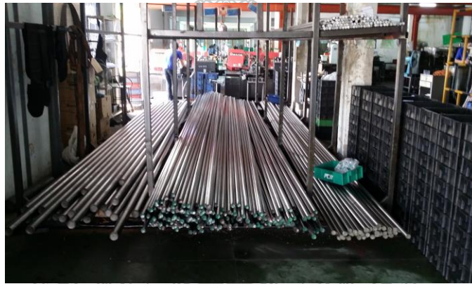
รูปที่ 3.5 เหล็กกล้าคาร์บอนปานกลาง (Medium Carbon Steel) เกรด SS400
