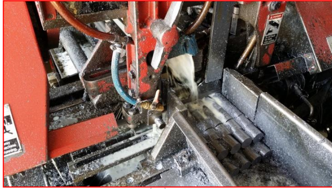
รูปที่ 3.7 ขั้นตอนการตัดวัสดุดิบ
