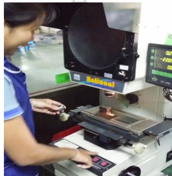
รูปที่ 3.26 การใช้เครื่องวัดขนาดชิ้นงานละเอียดแบบแสงเงา
