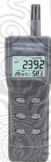
รูปที่ 3.2 เครื่องวัดปริมาณก๊าซคาร์บอนไดออกไซด์และความชื้นสัมพัทธ์ โดยเครื่องมือวัด ยี่ห้อ AZ รุ่น 77535
