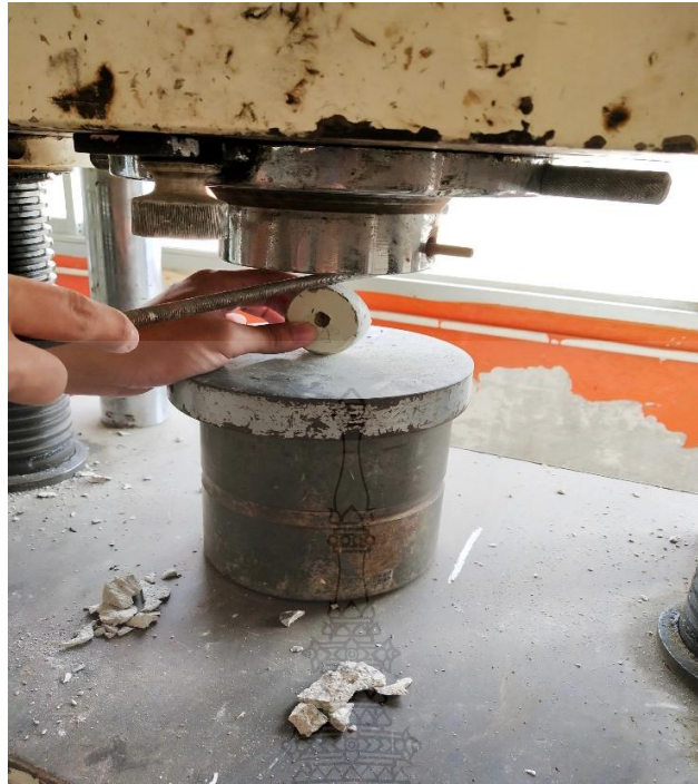
รูปผนวกที่ ข7 นำตัวอย่างคอนกรีตที่ได้จากการเจาะจากตำแหน่งที่กล่าวมา นำมาผ่าซีกด้วยเครื่องทดสอบ Universal Testing Machine (UTM)
