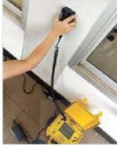
ภาพที่ 1 การวัดระยะ คอนกรีตหุ้มเหล็กเสริม
