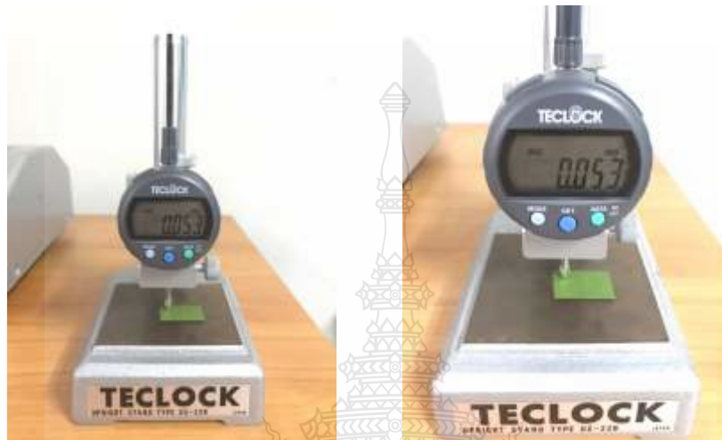
รูปที่ ค.1 เครื่องทดสอบความหนาอย่างละเอียด หรือ ไมโครมิเตอร์ ยี่ห้อ Teclock รุ่น Upright Stand Type US-22B
