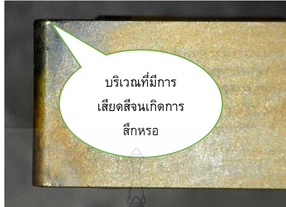
ภาพที่ 4.9 แสดงการสึกหรอการกลึงแบบไม่ใช้สารหล่อเย็น
