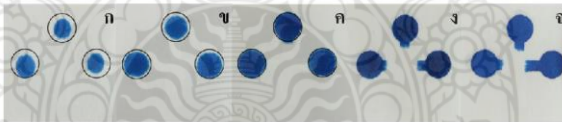
ภาพที่ 6 การศึกษาปริมาตรที่เหมาะสมของสารเคมีบริเวณตัวอย่าง ก) 1 ข) 2 ค) 3 ง) 4 และ จ) 5 ไมโครลิตร
