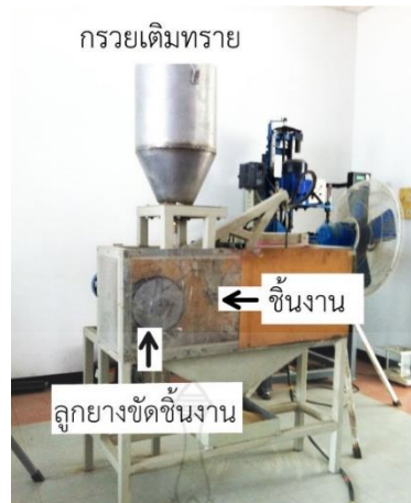
รูปที่ 2.5 เครื่องทดสอบการสึกหรอที่สร้างขึ้นตาม ASTM G65
