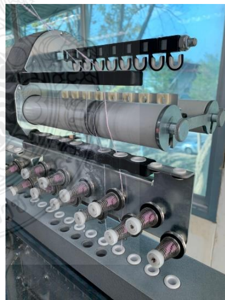
(ข) ร้อยเส้นด้ายผ่านลูกกลิ้งดึงชุดเซนเซอร์เส้นด้าย
