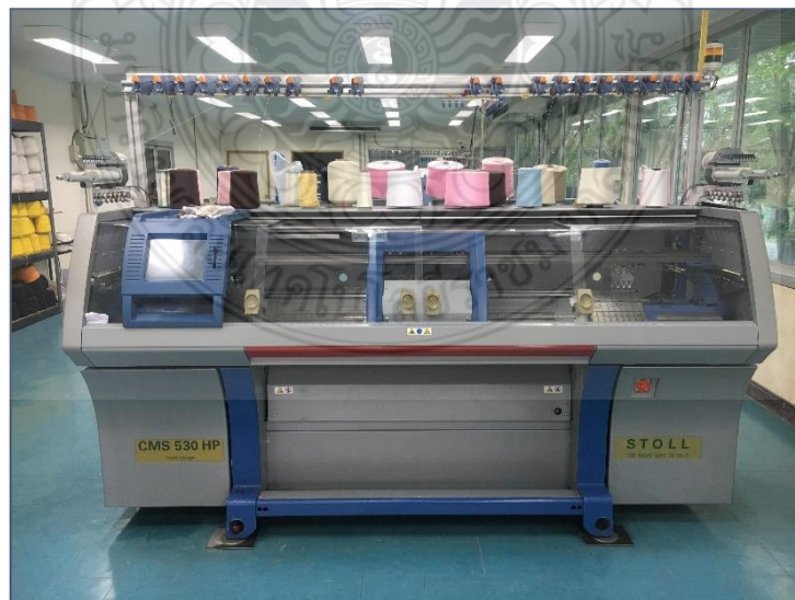
รูปที่ 3.4 เครื่องถักผ้าลวดลายแพชชั่นอัตโนมัติ ยี่ห้อ STOLL 530HP E6.2
