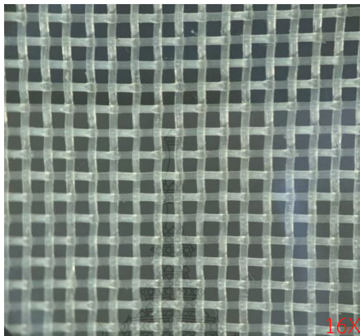
รูปที่ 4.2 มุ้งตาข่าย 40 ตาผ่านกล้อง Optical microscope
