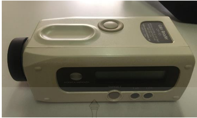
รูปที่ 3.3 เครื่องวัดค่าสียี่ห้อ Konica Minolta (Color Reader CR-10) ช่วงแสดงผล L *: 1 ถึง 100
