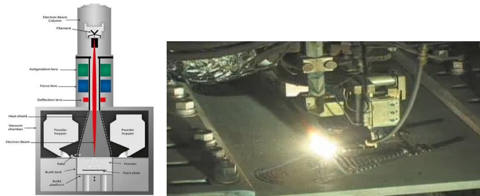
ภาพที่ 2.23 กรรมวิธีการขึ้นรูป แบบ Electron Beam Melting (EBM) [37]
