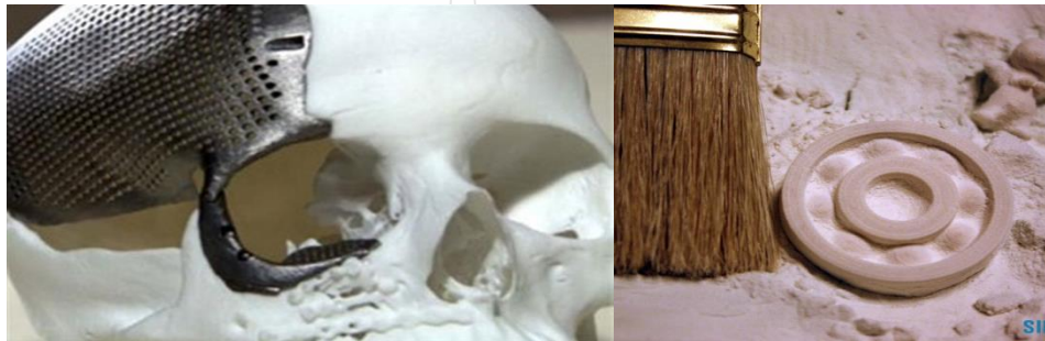
ภาพที่ 2.22 ชิ้นงานที่ได้จากกรรมวิธี Selective Laser Sintering (SLS) หรือ Selective Laser Melting (SLM) [36]
