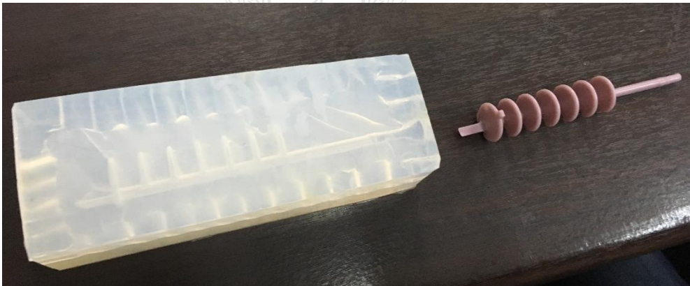
ภาพที่ 4.8 แม่พิมพ์ซิลิโคนจากกระบวนการฉีดเทียบทางอุตสาหกรรมเครื่องประดับและชิ้นงานตัวอย่างของแกนซีฟู้งที่ผ่านการฉีดเทียบ
