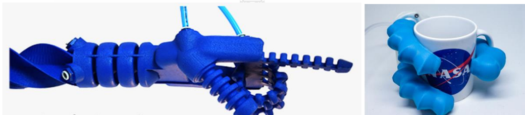
ภาพที่2.6 หุ่นยนต์นิ่มที่มีลักษณะคล้ายมือมนุษย์ ช้าย : หุ่นยนต์นิ่มจากการพิมพ์ สามมิติ [18] ชาว : หุ่นยนต์ ELabNYC [19]
