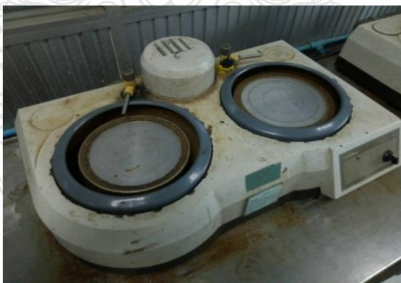
รูปที่ 3.18 เครื่องขัดแบบจานหมุนใช้กระดาษทราย
