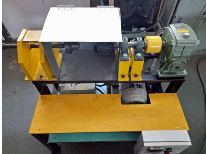
รูปที่ 3.6 อุปกรณ์จับยึดชิ้นงานสำหรับการเชื่อม
