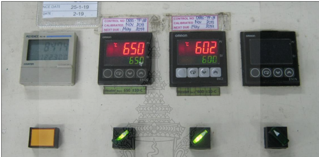
ภาพที่ 4.5 หน้าจอแสดงอุณหภูมิเครื่อง Fuhai
