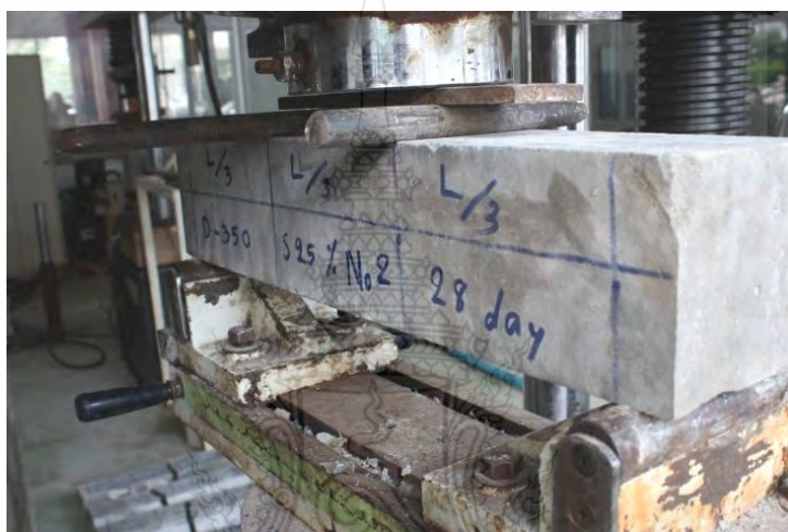
รูปที่ 3.8 เครื่องทดสอบค่าโมดูลัสการแตกร้าว (Modulus of Rupture)
