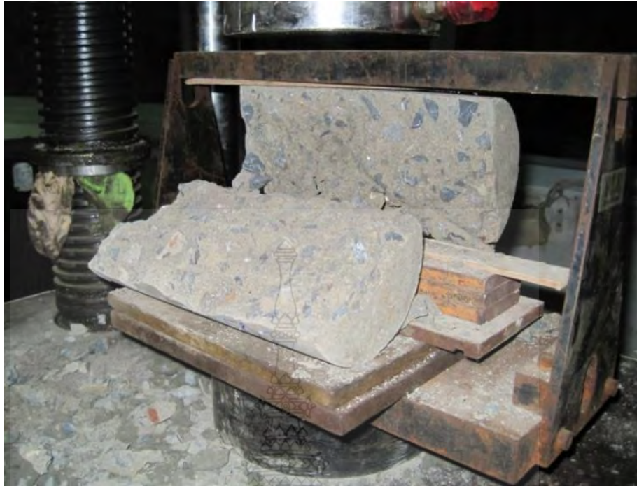
รูปที่ 2.2 การวัดค่าการรับแรงดึงด้วยวิธีผ่าซีก (Splitting strength)
