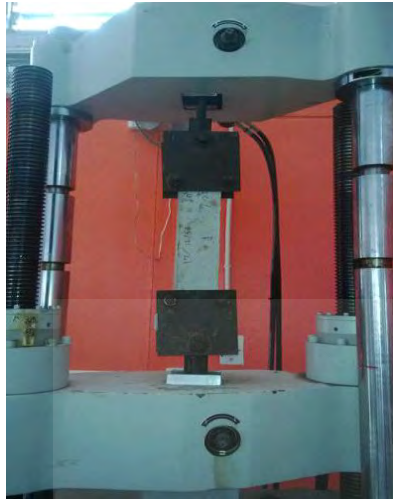
รูปที่ 3.6.3 การทดสอบคอนกรีตตัวอย่างกำลังรับแรงดึงโดยตรง (Direct Tensile Strength)
