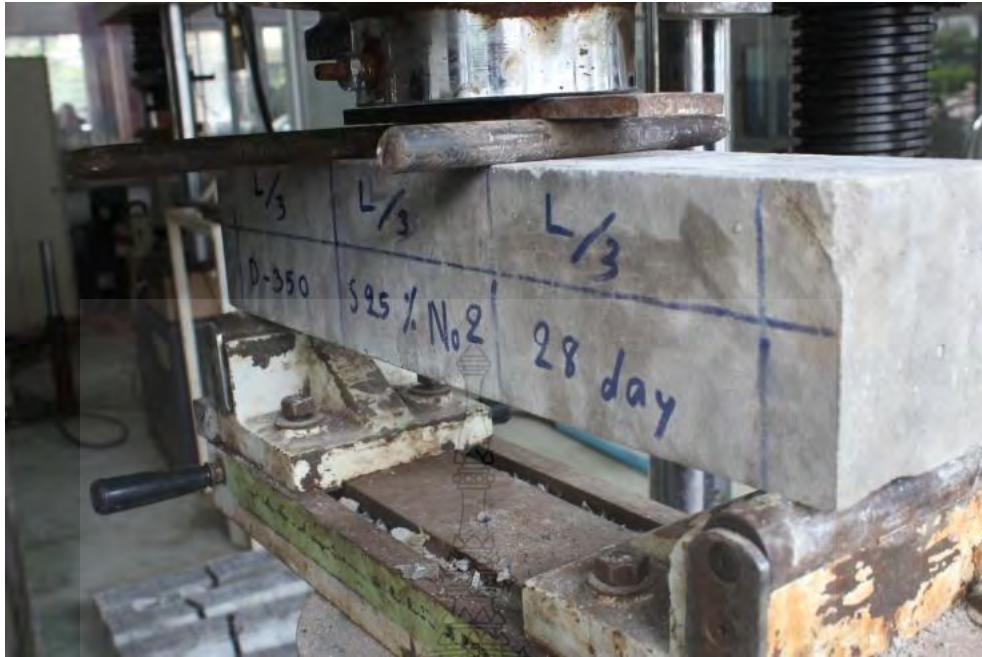
รูปที่ 2.3 การคอนกรีตตัวอย่างของการทดสอบแรงดึงทางอ้อมโดยวิธีโมดูลัสการแตกร้าว (Modulus of Rupture)
