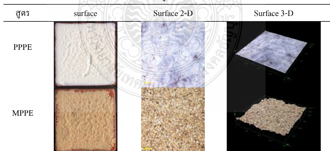
ตารางที่ 4.12 รูปถ่ายผิวหน้าด้วยกล้องจุลทรรศน์แบบใช้แสง (Optical Microscope) ของแผ่นกระเบื้องที่เคลือบด้วยสารเคลือบสูตร PPPE และ MPPE
