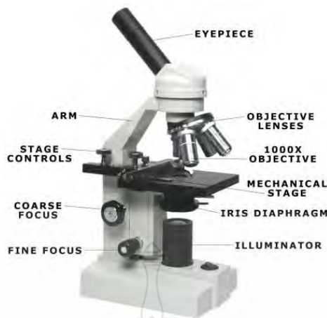
รูปที่ 2.18 ส่วนประกอบของกล้องจุลทรรศน์แบบใช้แสง Optical Microscope [25]
