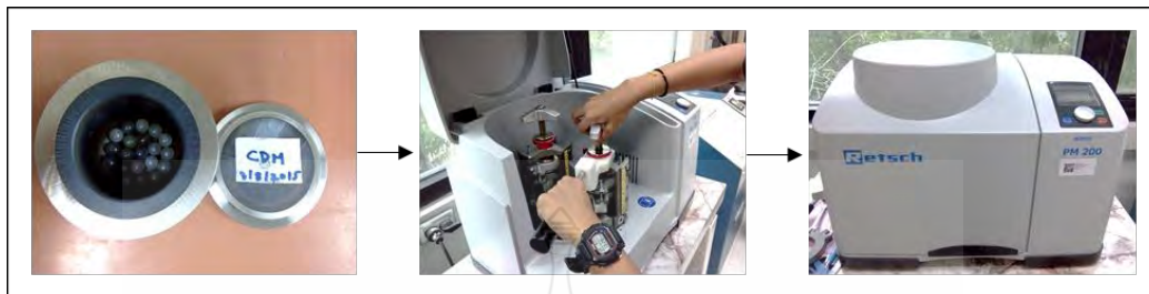
รูปที่ 3.5 การบดแร่ด้วยเครื่องบดละเอียดความเร็วสูง (Planetary ball mill)
