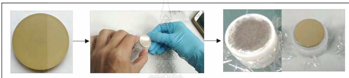
รูปที่ 3.15 การเตรียมตัวอย่างเพื่อทดสอบด้วยเทคนิคการเรืองรังสีเอกซ์ (Micro Energy Dispersive X-ray Fluorescence Spectrometer ; \mu -EDXRF)
