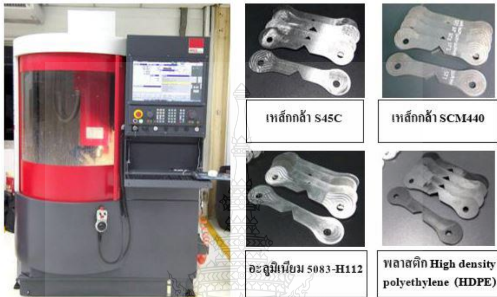
รูปที่ 3.2 เครื่องมิลลิ่งสำหรับขึ้นรูปชิ้นงานทดสอบ
