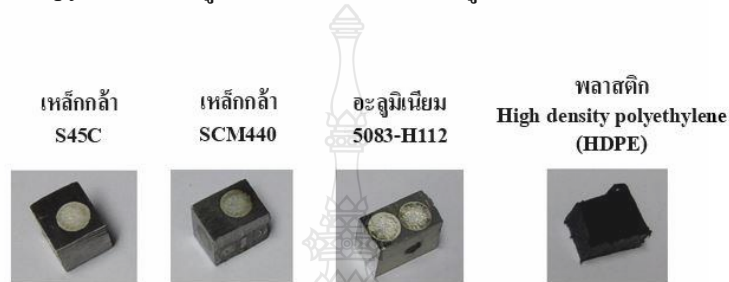
รูปที่ 3.7 ชิ้นงานทดสอบหาปริมาณส่วนผสมแร่ธาตุของวัสดุ
