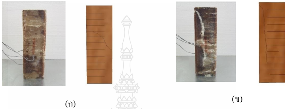
รูปที่ 4.12 (ก) การวิบัติของเสาไม้เสียหายร้อยละ 50 มีการเสริมกำลังแบบพัน กดตามแนวแกน (ข) การวิบัติของเสาไม้เสียหายร้อยละ 50 มีการเสริมกำลังแบบพัน กดตามแนวแกน
