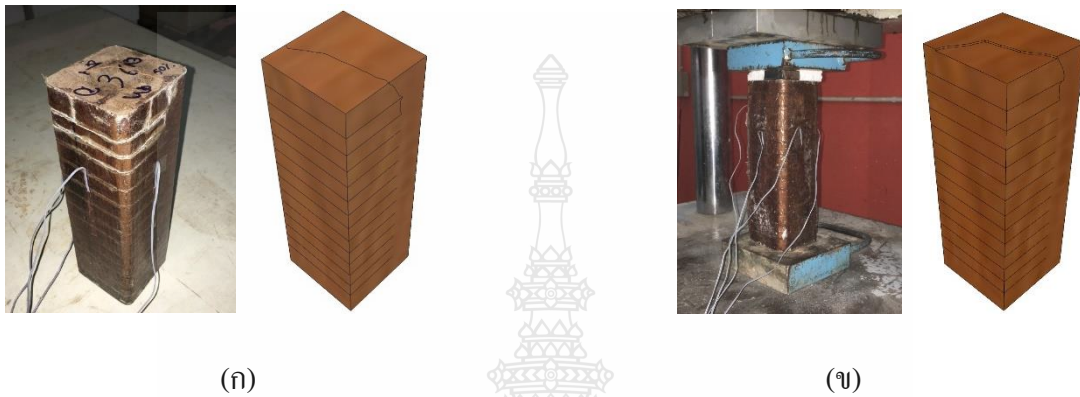
รูปที่ 4.18 (ก) การวิบัติของเสาไม้เสียหายร้อยละ 50 มีการเสริมกำลังแบบพัน กดเยื้องศูนย์กลาง (ข) การวิบัติของเสาไม้เสียหายร้อยละ 50 มีการเสริมกำลังแบบพัน กดเยื้องศูนย์กลาง
