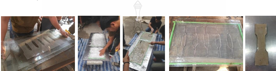
รูปที่ 3.18 การขึ้นรูปแผ่น GFRP ทั้งแบบ แผ่นผ้า (Sheet) และแบบเส้นใย (Sprayed)
