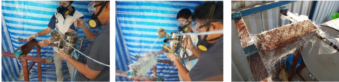
รูปที่ 3.14 การเตรียมตัวอย่างเสาไม้เสริมด้วยการพ่นเส้นใย GFRP
