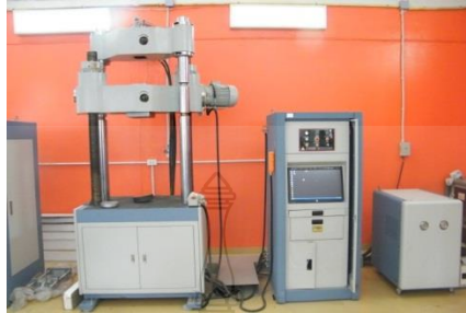
รูปที่ 3.7 เครื่องทดสอบ Universal Testing Machine ขนาด 100 ตัน
