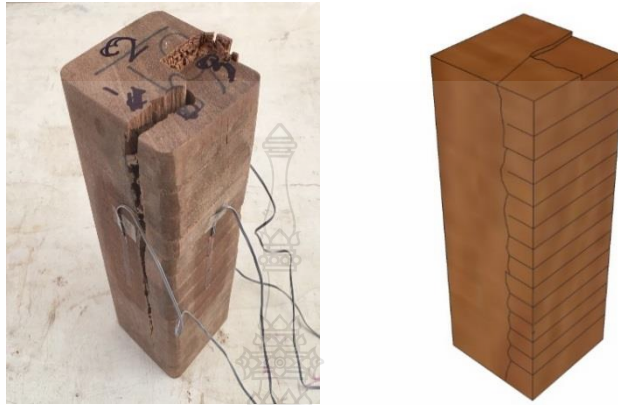
รูปที่ 4.14 การวิบัติของเสาไม้เสียหายร้อยละ 25 ไม่มีการเสริมแรงกคเฉียงศูนย์กลาง
