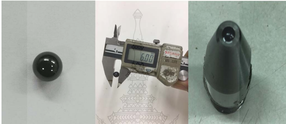
รูปที่ 3.1 ขนาดของบอลกรัดผิวแข็งใช้งาน
