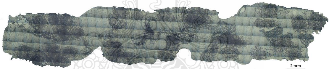
รูปที่ ข-23 ภาพ โครงสร้างภาคตัดขวางที่ความเร็วของการพุดทรวงั้น 140 มิลลิเมตร/นาที่
