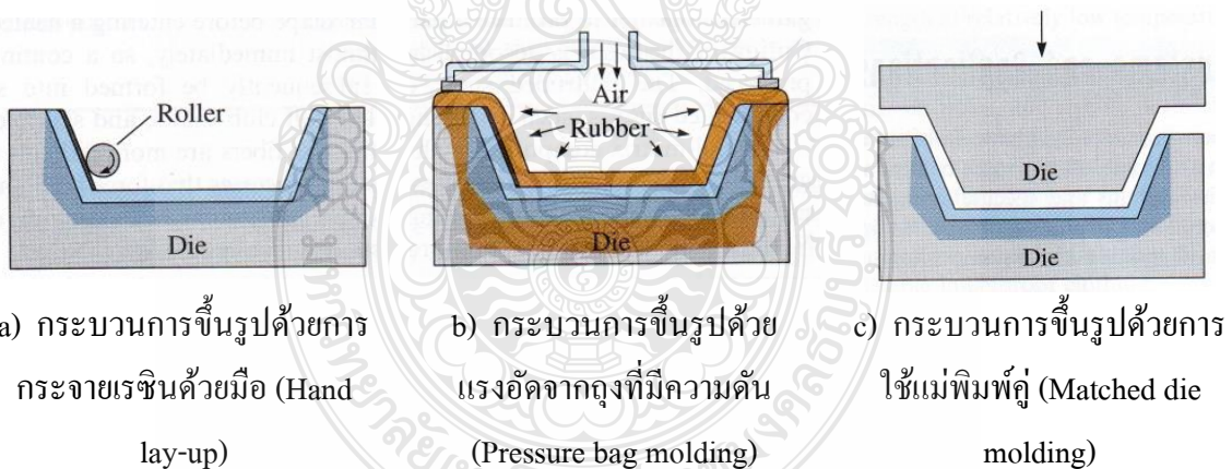
รูปที่ 2.7 การขึ้นรูปวัสดุคอมโพสิตด้วยแม่พิมพ์ [1]
