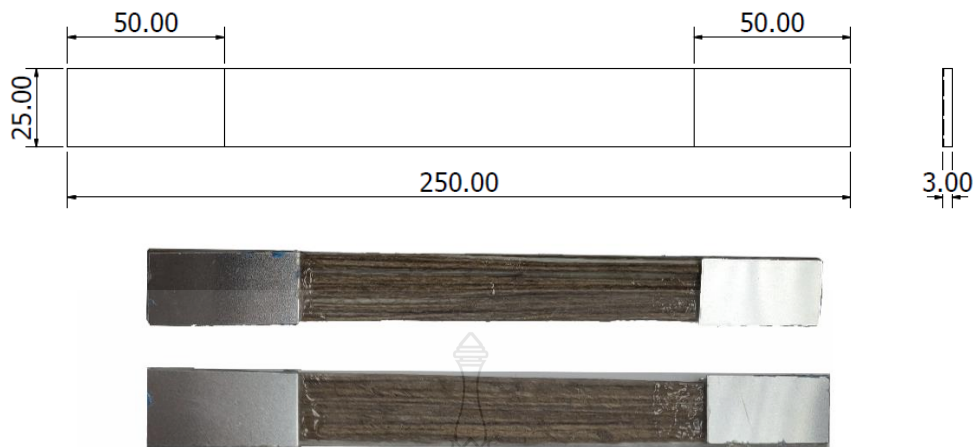
รูปที่ 3.30 แสดงลักษณะและขนาดของชิ้นงานทดสอบแรงดึง
