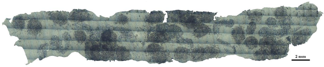
รูปที่ ข-21 ภาพ โครงสร้างภาคตัดขวางที่ความเร็วของการพุดทรวงั้น 100 มิลลิเมตร/นาที่
