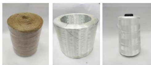
รูปที่ 2 ลักษณะของเส้นใยที่ใช้ในการพลาทูลูชั่น
