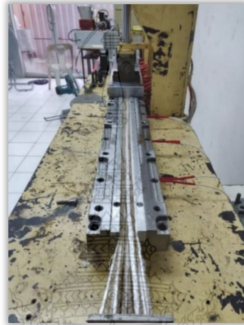
รูปที่ 3.22 ลักษณะการเตรียมเส้นใยก่อนปิดแม่พิมพ์
