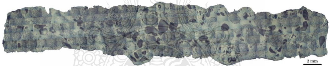
รูปที่ ข-19 ภาพ โครงสร้างภาคตัดขวางที่อุณภูมิพลทรูชั้น 220 องศาเซลเซียส
