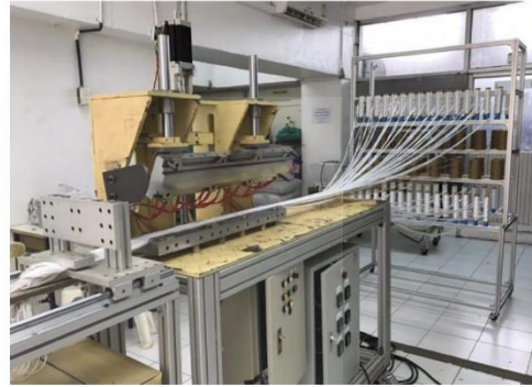
รูปที่ 3 การเตรียมเส้นใยเตรียมพร้อมสำหรับพลาทูลูชั่น
