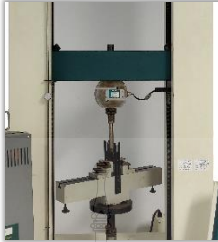
รูปที่ 3.13 เครื่อง Universal testing machine สำหรับทดสอบการดัดแบบ 3 จุด
