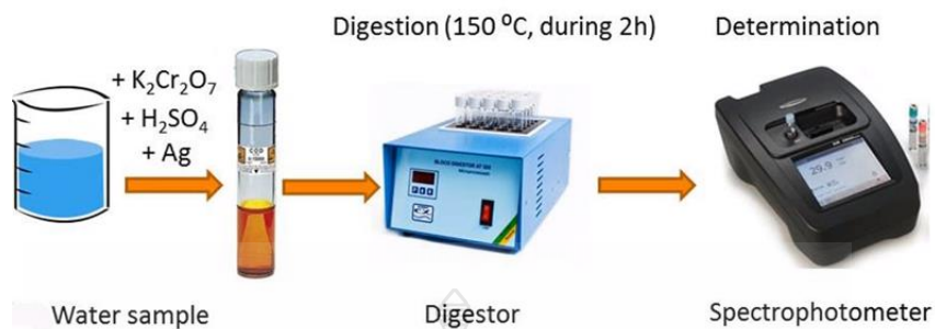
ภาพที่ 2.2 วิธีการรีฟลักซ์แบบปิดโดยการวัดสี
