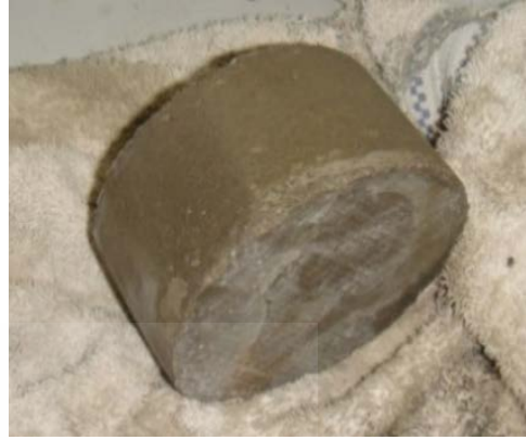
ง) ตัวอย่างคอนกรีตที่ตัดเสร็จแล้ว
