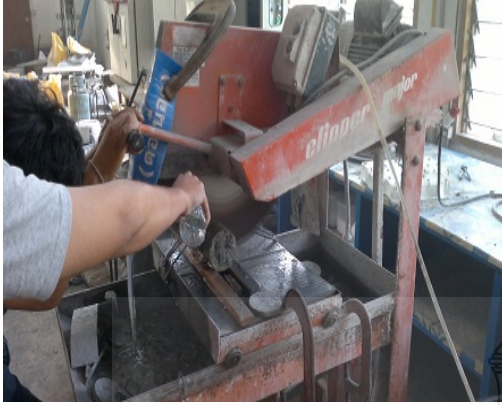
ค) การตัดคอนกรีต
