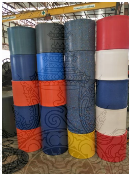
รูปที่ 4.3 ผลิตภัณฑ์ที่เกิดจากการขึ้นรูปด้วยเครื่องขึ้นรูปพลาสติกแบบหมุนเคลื่อนที่สำหรับกลุ่มสถานประกอบการเกษตรขนาดกลาง และขนาดย่อม
