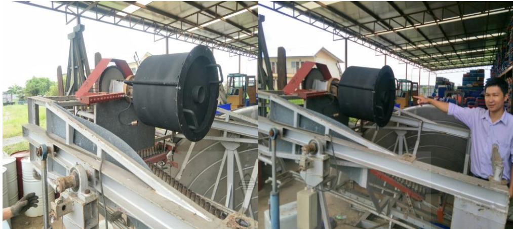
รูปที่ 3.3 เครื่องขึ้นรูปพลาสติกแบบหมุนรุ่นเดิม : Rock N Roll
