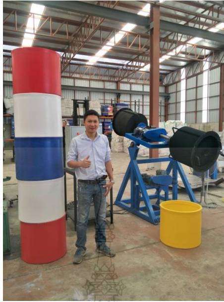
รูปที่ 4.5 เครื่องขึ้นรูปพลาสติกแบบหมุนเคลื่อนที่สำหรับกลุ่มสถานประกอบการเกษตรขนาดกลาง และขนาดย่อม
