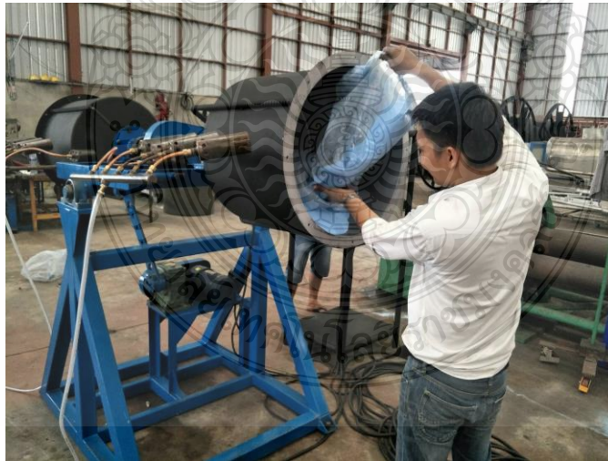
รูปที่ 3.12 การเทผงพลาสติกใส่ในแม่พิมพ์
