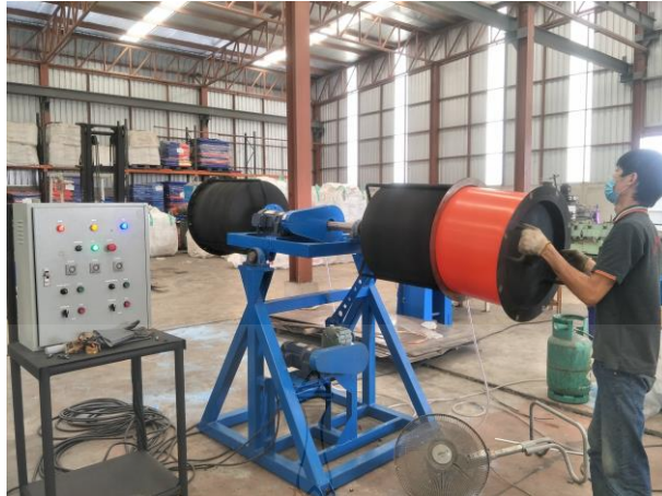
รูปที่ 3.4 การถอดชิ้นงานออกจากแม่พิมพ์
