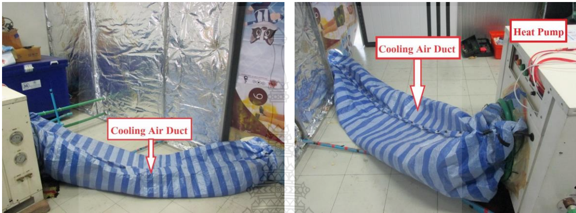
รูปที่ 3.5 ชุดอุปกรณ์ดึงอากาศเย็นที่เกิดจากการแลกเปลี่ยนความร้อนออกจากห้องทดสอบ
