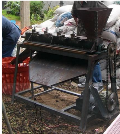
รูปที่ 2.2 ทดสอบและพัฒนาเครื่องกะเทาะเปลือกเขียวมะคาเดเมีย [9]
