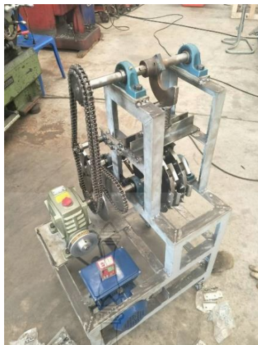
รูปที่ 4.5 เครื่องกะเทาะเมล็ดกระบะที่ออกแบบและสร้างเสร็จ
