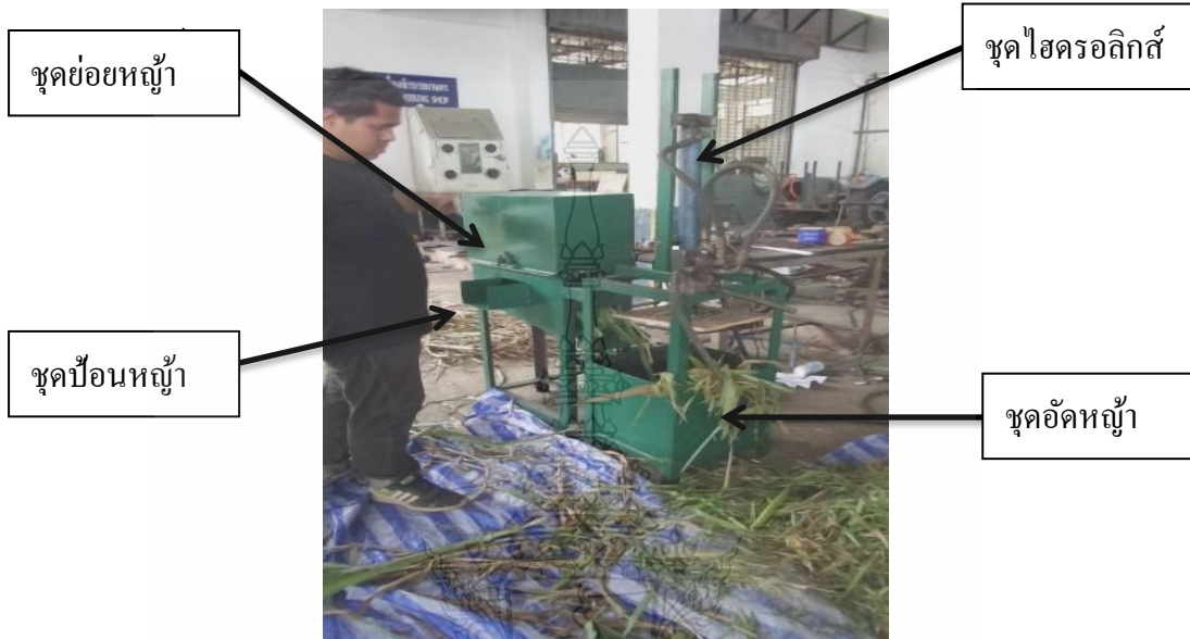
ก) เครื่องย่อยและอัดหญ้าอาหารสัตว์ต้นแบบ
