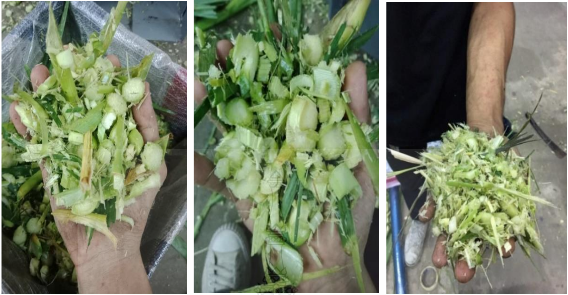
ก) ไบมีดมูมคม 15 องศา ข) ไบมีดมูมคม 30 องศา ค) ไบมีดมูมคม 40 องศา รูปที่ 4.8 ลักษณะของหญ้าที่ถูกสับย่อยที่มุมองศาของไบมีด 15, 30 และ 40 องศา
