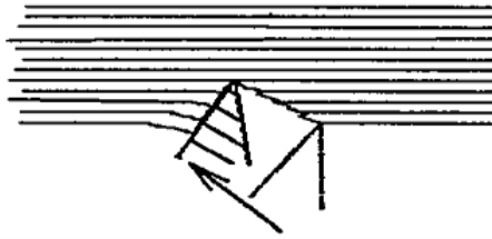
รูปที่ 2.28 ลักษณะการตัดแบบ Scraping cut [13]
