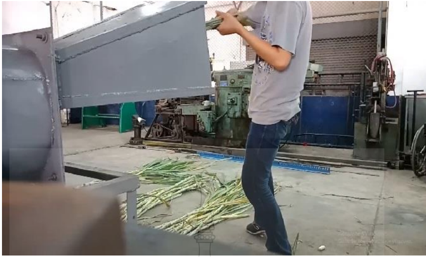
รูปที่ ก.3 หญ้าเนเปียร์ที่ถูกย่อยด้วยชุดใบมีดที่พัฒนาขึ้น
