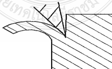
รูปที่ 2.25 ลักษณะการตัดแบบ Chip forming cut [13]
