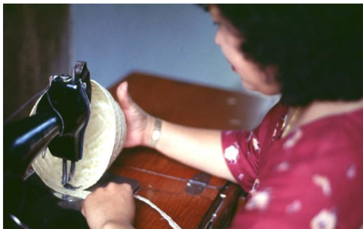
ภาพที่ 54 การเย็บเส้นเปียให้ต่อเนื่องให้เป็นรูปหมวก
