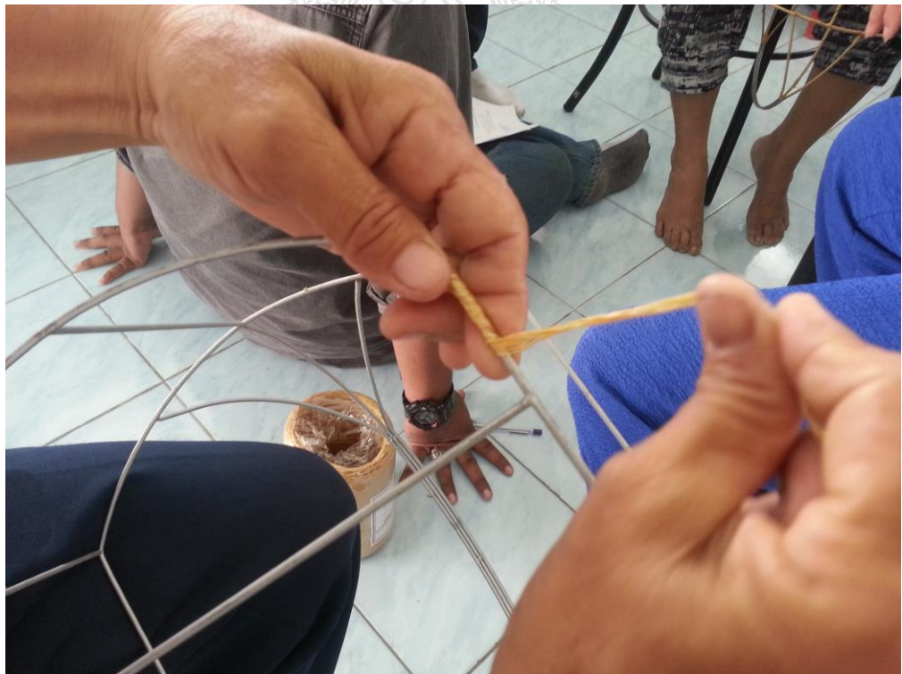
ภาพที่ 90 การพันเส้นป่านมหัศจรรย์รอบโครงเหล็ก
