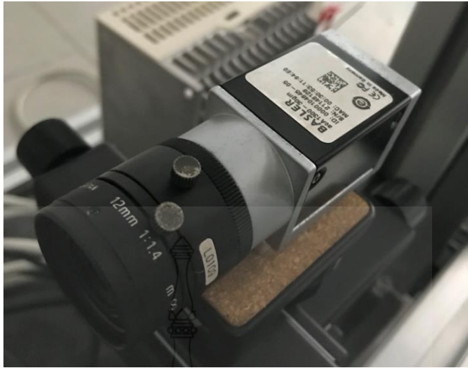
รูปที่ 3.2 กล้องรับภาพแบบพื้นที่ชี้หือ Basler ace รุ่น Aca 1300 – 30 gm
