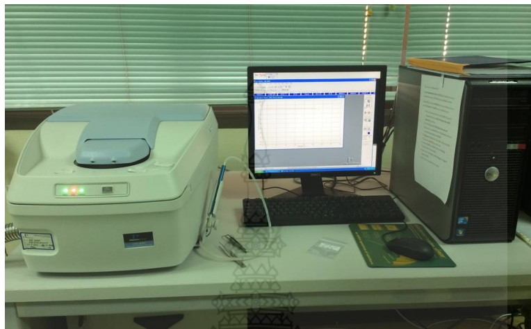
รูปที่ 3.5 เครื่องดิฟเฟอเรนเชียลสแกนนิ่งแคลลอรีมิเตอร์ (Differential Scanning Calorimeter)
