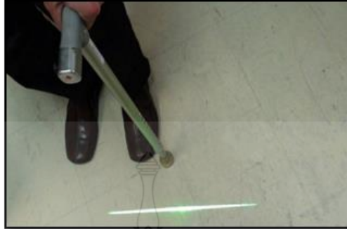
ภาพที่ 2.16 ไม้เท้าเลเซอร์ (laser cane) ซึ่งเป็นไม้เท้าที่มีระบบตรวจจับ (sensor) กล้องส่องทางไกลสำหรับคู่มือตาบอดที่อยู่ในระยะไกล [30]
