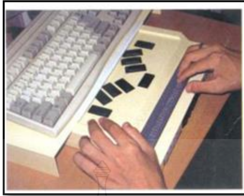
ภาพที่ 2.22 เครื่องแสดงผลอักษรเบรลล์ (braille display) [36]
