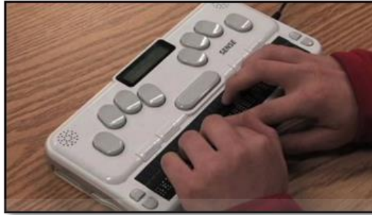
ภาพที่ 2.19 เครื่องจดบันทึกอักษรเบรลล์ (braille notetaker) เป็นคอมพิวเตอร์แบบพกพาสำหรับผู้ที่มีความบกพร่องทางการ [33]
