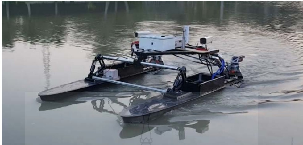
รูปที่ 3.1 หุ่นยนต์เรือสองล้อแบบปรับตัวตามคลื่น
