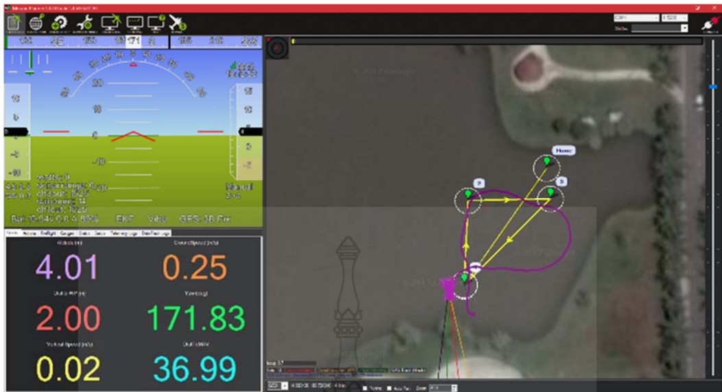
รูปที่ 4.10 โปรแกรม Mission Planner ที่ใช้เชื่อมต่อกับผู้ใช้งาน (Interface) สำหรับการติดตามและวางแผนจุดพิกัดการควบคุมหุ่นยนต์เรือสองท่อนแบบปรับตัวตามคลื่น อย่างอัตโนมัติ
