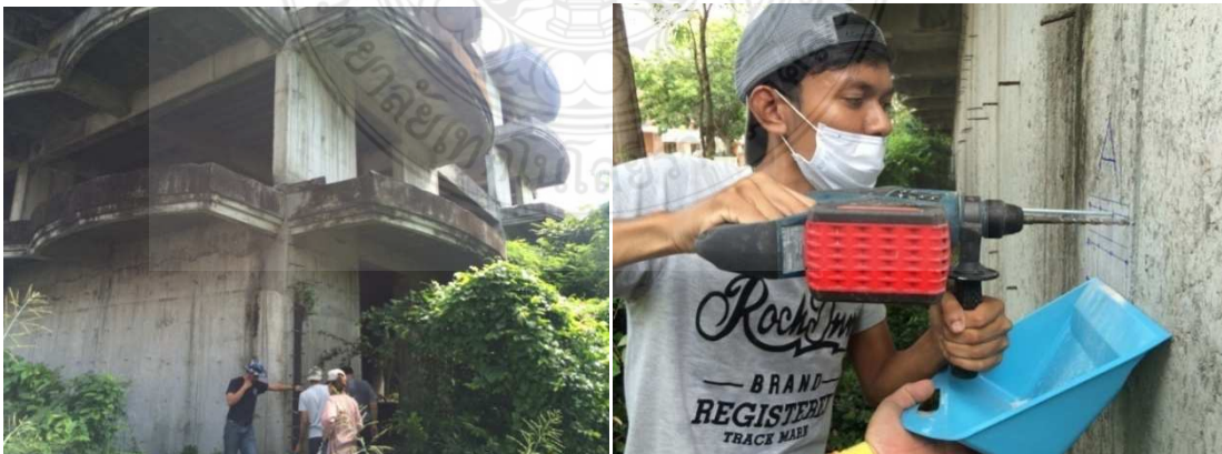
รูปที่ 3.4 ภาพถ่ายสถานที่จริงอาคารค.ส.ล. 5 ชั้น โดยทำการเก็บตัวอย่างผงคอนกรีตจากผนัง
