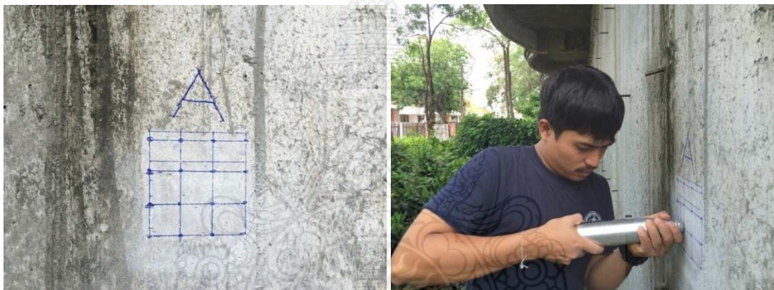
รูปที่ 3.13 การวัดค่า Rebound number ด้วยเครื่อง Schmidt hammer ที่ผิวหน้าของโครงสร้าง
