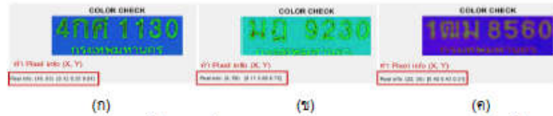
รูปที่ 11 (ก) แสดงการหาค่าช่วงสีของสีพื้นหลังบนป้ายทะเบียน (ข) แสดงการหาค่าช่วงสีเหลืองของสีพื้นหลังบนป้ายทะเบียน (ค) แสดงการหาค่าช่วงสีเขียวของสีตัวอักษรบนป้ายทะเบียน
