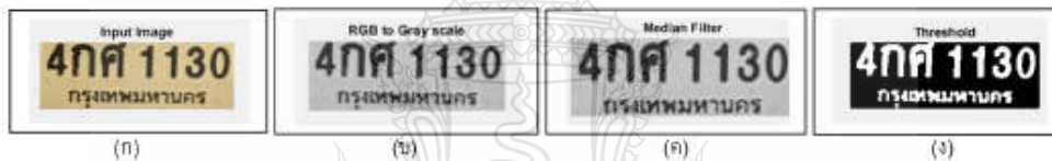
รูปที่ 3 (ก) ภาพต้นฉบับ (ข) Gray scale image (ค) Median filtering image (ง) Threshold image
