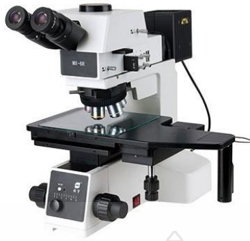
รูปที่ 3.9 อุปกรณ์ที่ใช้ในการตรวจสอบโครงสร้างจุลภาค
