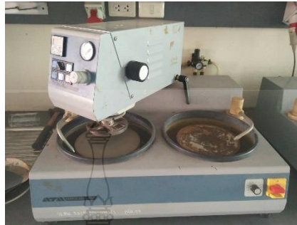
รูปที่ 3.11 เครื่องขัดชิ้นงานที่ใช้ในการทดสอบการสึกหรอ
