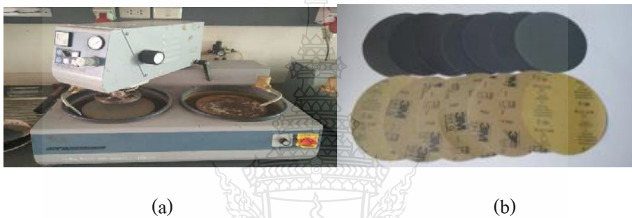
รูปที่ 2.7 (a) เครื่องขัดแบบจานหมุน (b) กระดาษทรายที่ใช้ขัด
