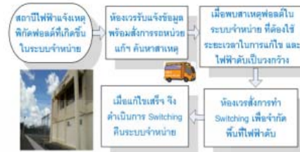
รูปที่ 1 ขั้นตอนการแก้ไขกระแสไฟฟ้าขัดข้องในระบบจำหน่าย กฟภ.
