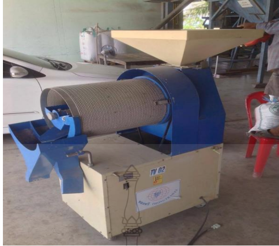
รูปที่ 4.4 เครื่องคัดขนาดข้าวขนาดเล็ก โรงสีบ้านทองคริม
