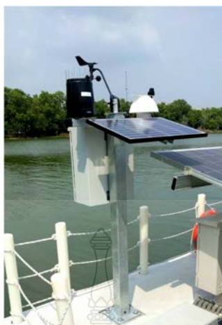
รูปที่ 3.15 สถานีโทรมาตรบริเวณแพงโซลาร์เซลล์ที่ติดตั้งแบบลอยน้ำ
