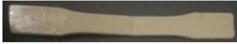
ภาพที่ ข4 การทดสอบแรงดึงของชั้นทดสอบที่ผสมผงเปลือกไข่ขนาด 200 เมช
