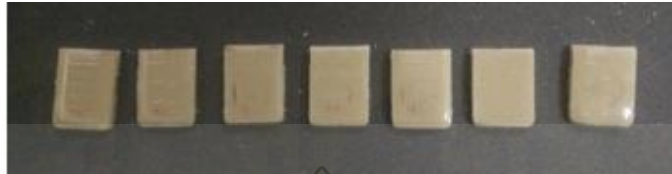
ภาพที่ ข19 การทดสอบความแข็งของชั้นทดสอบที่ผสมผงเปลือกไข่นกนางแอตขนาด 325 เมช
