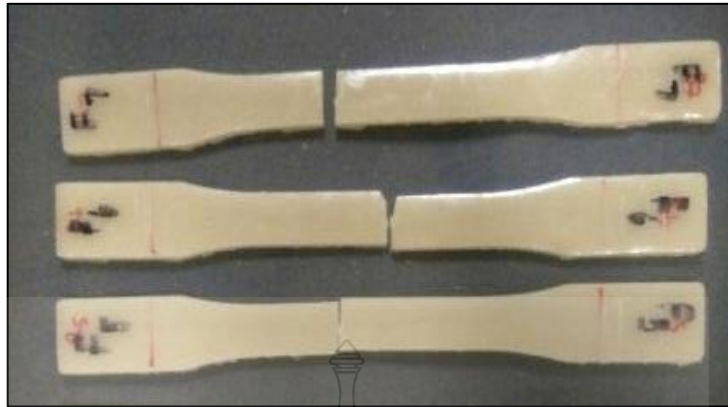
ภาพที่ 4.3 ชิ้นทดสอบค่าความต้านทานแรงดึงสำหรับการหล่อจากผงเปลือกไข่เติมในอีพอกซีเรซิน
