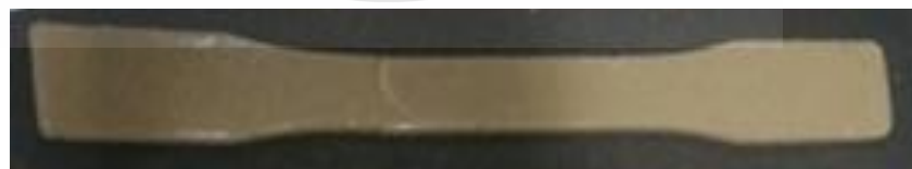
ภาพที่ ข7 การทดสอบแรงดึงของชั้นทดสอบที่ผสมผงเปลือกไข่ขนาด 200 เมช ที่มีการปรับปรุงผิว
