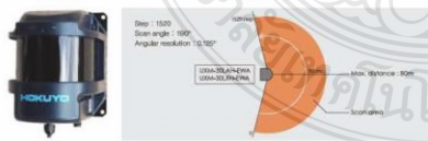
รูปที่ 8 เลเซอร์สแกนเนอร์ของ Hokuyo รุ่น UXM30LXH-EWA [12]
