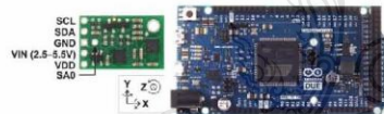
รูปที่ 7 เซนเซอร์วัดมุมเอียงแบบ 9 แกนขนาดเล็ก (MinIMU-9) ของ Pololu [10] (ซ้าย) และ ไมโครคอนโทรลเลอร์ Arduino DUE [11] (ขวา)
