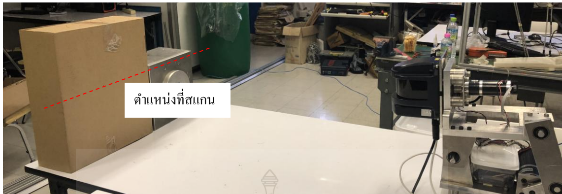
รูปที่ 4.21 ตำแหน่งที่สแกนของวัตถุ 2 ชนิด ที่วัดด้วยเลเซอร์สแกนเนอร์
