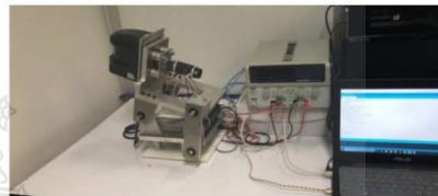
รูปที่ 16 อุปกรณ์ต่างๆ สำหรับทดสอบการทำงานชุดกลไกเพิ่มประสิทธิภาพเลเซอร์สแกนเนอร์
