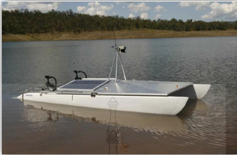
รูปที่ 1.1 เรือผิวน้ำอัตโนมัติสำหรับสำรวจคุณภาพน้ำ (Robotics and Automation (ICRA), 2010 IEEE International Conference) [1]
