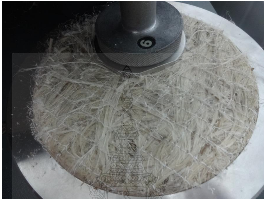
รูปที่ ข.15 แผ่นขัดผิวเส้นใยสับปะรดที่ผ่านการขัดถู ความยาว 9 เซนติเมตรหลังการขัดถู 15,000 รอบ
