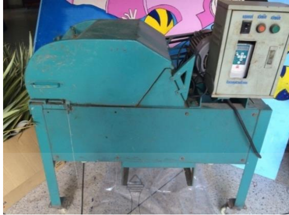
รูปที่ 3.2 เครื่องแยกเส้นใยแบบกึ่งอัตโนมัติ
