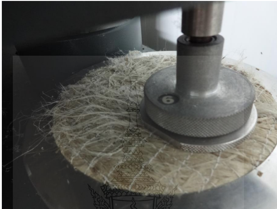
รูปที่ ข.10 แผ่นขัดผิวเส้นใยสับปรดที่ผ่านการขัดถู ความยาว 3 เซนติเมตรหลังการขัดถู 12,000 รอบ
